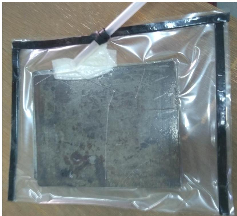
**Slika 13. Vakuumiranje granulata**
