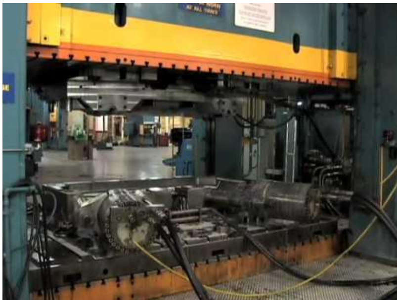
Slika 40. Williams-White 4000 tonska preša za hidrooblikovanje cijevi [35]
