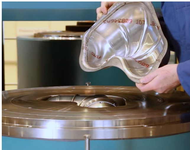
Slika 46. Alat za hidrooblikovanje limova [36]
