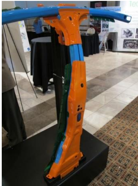
Slika 27. Hidrooblikovani B stup automobila Ford Fusion 2013 [25]
