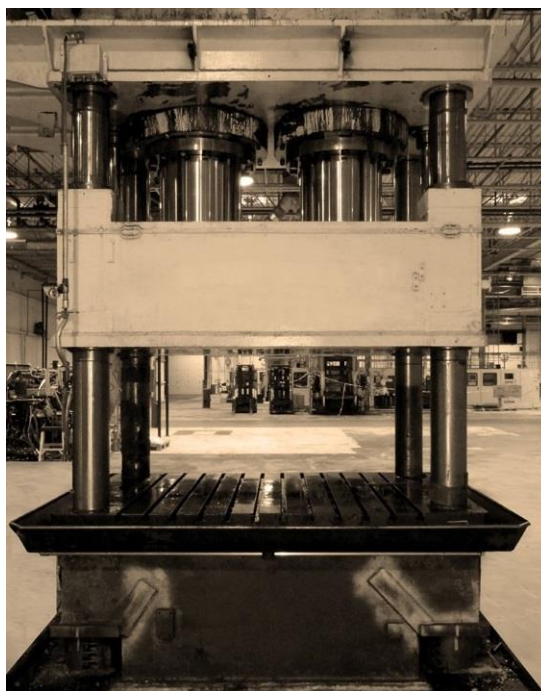
Slika 2. Preša za hidrooblikovanje proizvođača VariForm [4]
