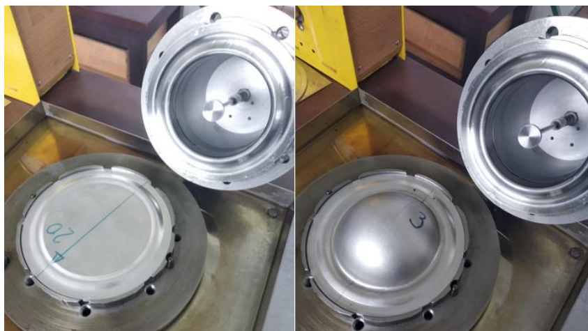
Slika 54. Rondela prije i nakon hidrauličkog udubljivanja
