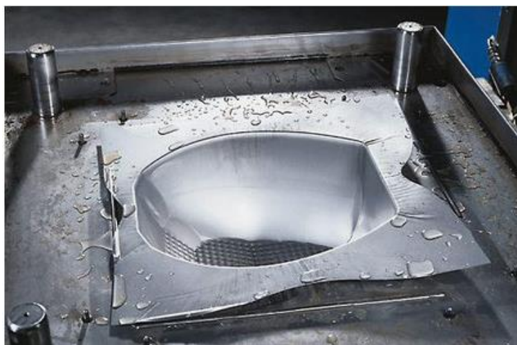
Slika 37. Vađenje proizvoda nakon završetka ciklusa hidrooblikovanja [31]
