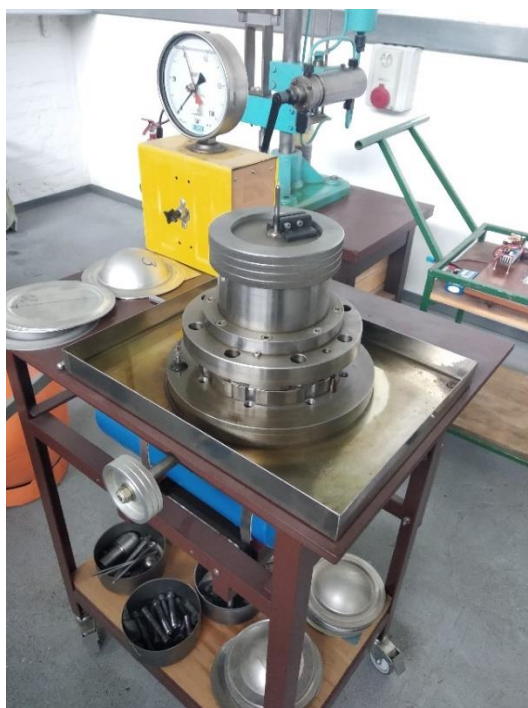
Slika 53. Naprava za hidrauličko udubljivanje
