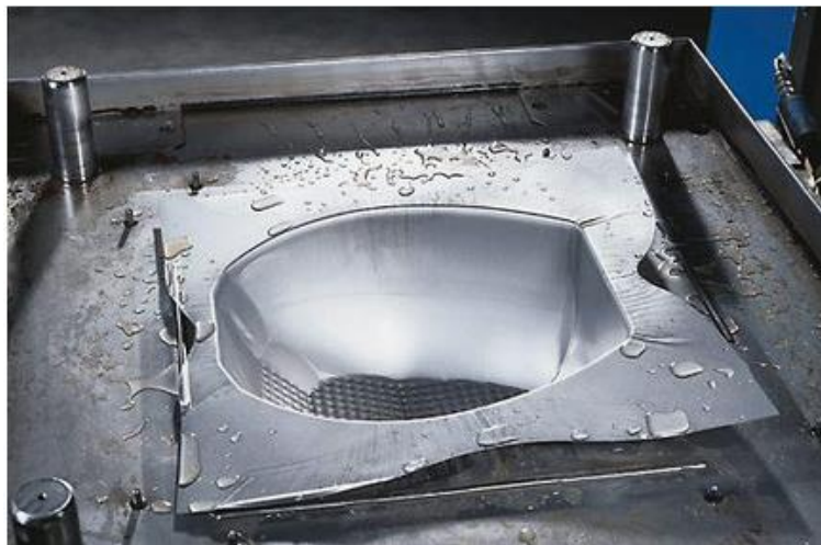
Slika 37. Vađenje proizvoda nakon završetka ciklusa hidrooblikovanja [31]
