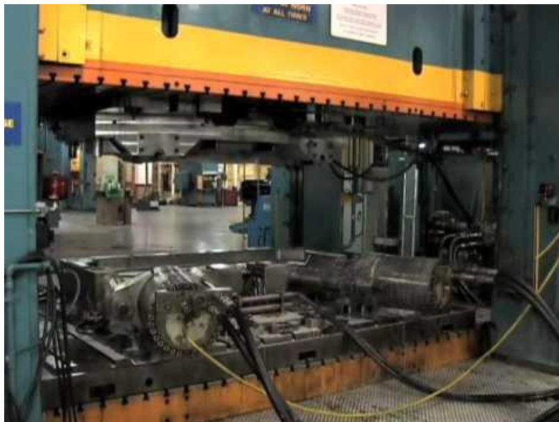
Slika 40. Williams-White 4000 tonska preša za hidrooblikovanje cijevi [35]
