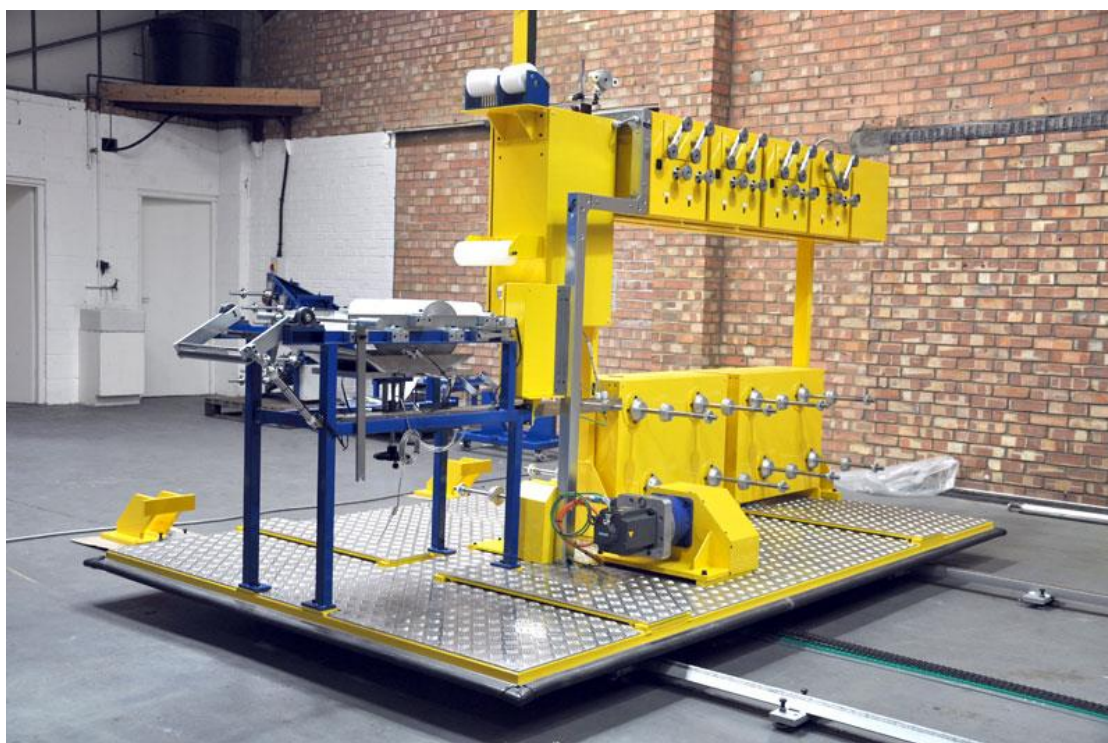
Slika 17. PULTREX sustav sa servo upravljanjem [8]
