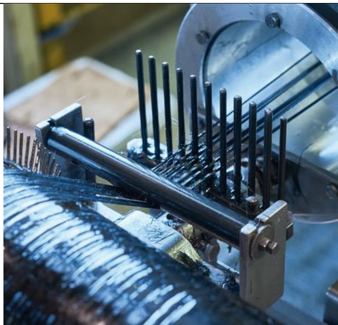
Slika 15. Glava za vođenje sa češljem [12]
