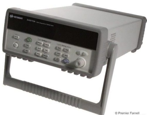
Slika 20. Keysight 34970A za prikupljanje podataka tijekom mjerenja [15]
