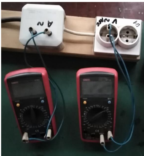
Slika 19. Mjerni uređaji: ampermetar (lijevo), voltmetar (desno).
