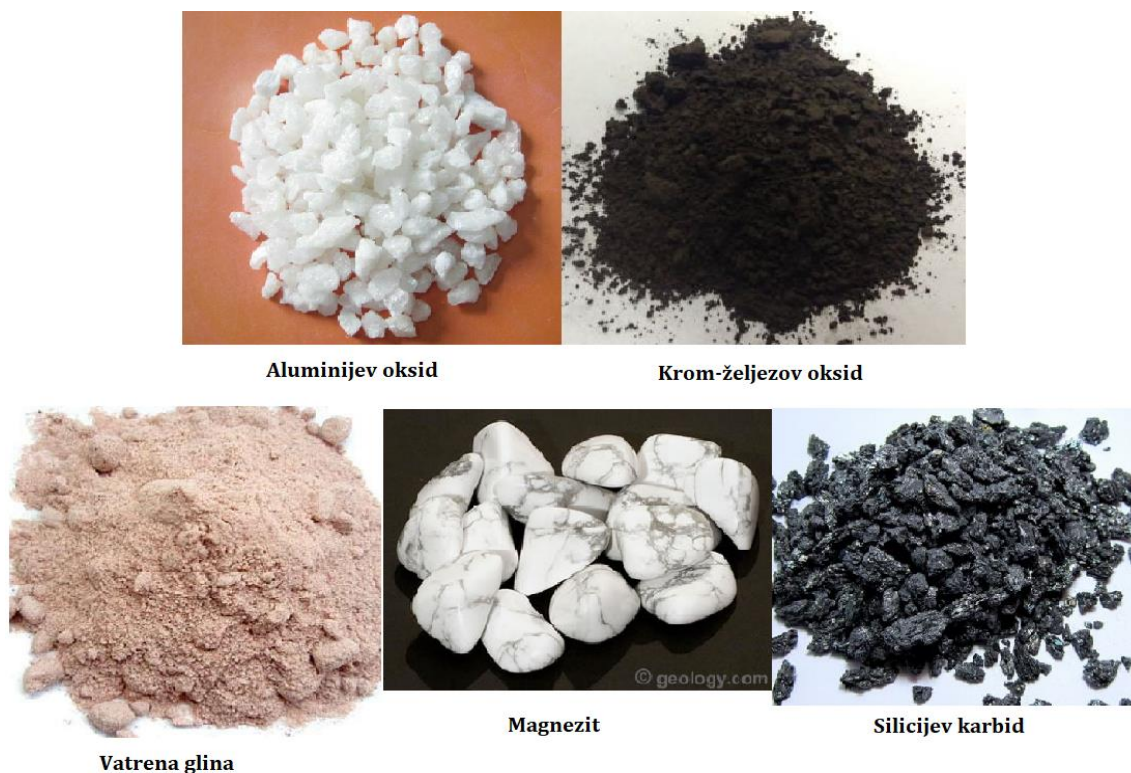
Slika 3. Minerali korišteni u vatrootpornim materijalima
