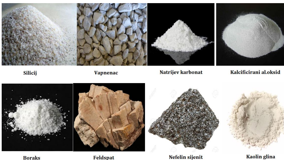
Slika 4. Materijali korišteni za izradu staklenog vlakna
