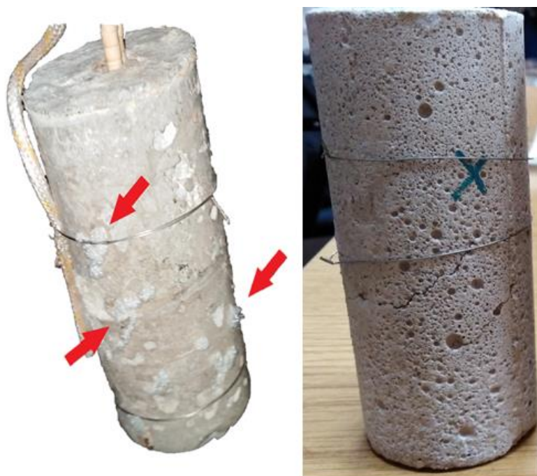
Slika 26. Uzorak betona nakon mjerenja (lijevo). Uzorak žbuke nakon mjerenja (desno).
