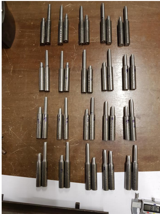
Slika 17. Prikaz slomljenih epruveta
