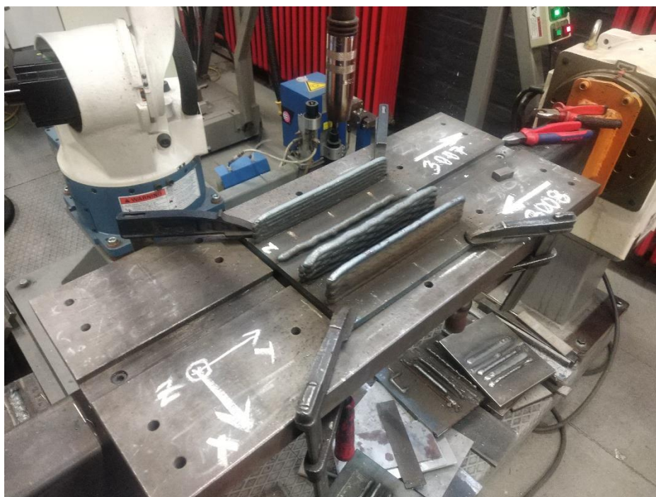
Slika 55. Izrađeni 2., 3. i 4. zid
