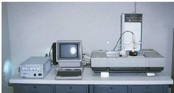
Slika 3. Prvi komercijalno raspoloživi sustav za aditivnu proizvodnju SLA-1 [3]
