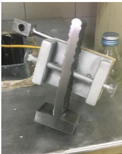
Slika 33. Uzorak 1 nakon nagrivanja
