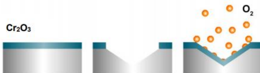
Slika 14. Prikaz mehanizma samoobnavljanja pasivnog filma kromovih oksida na površini [19]
