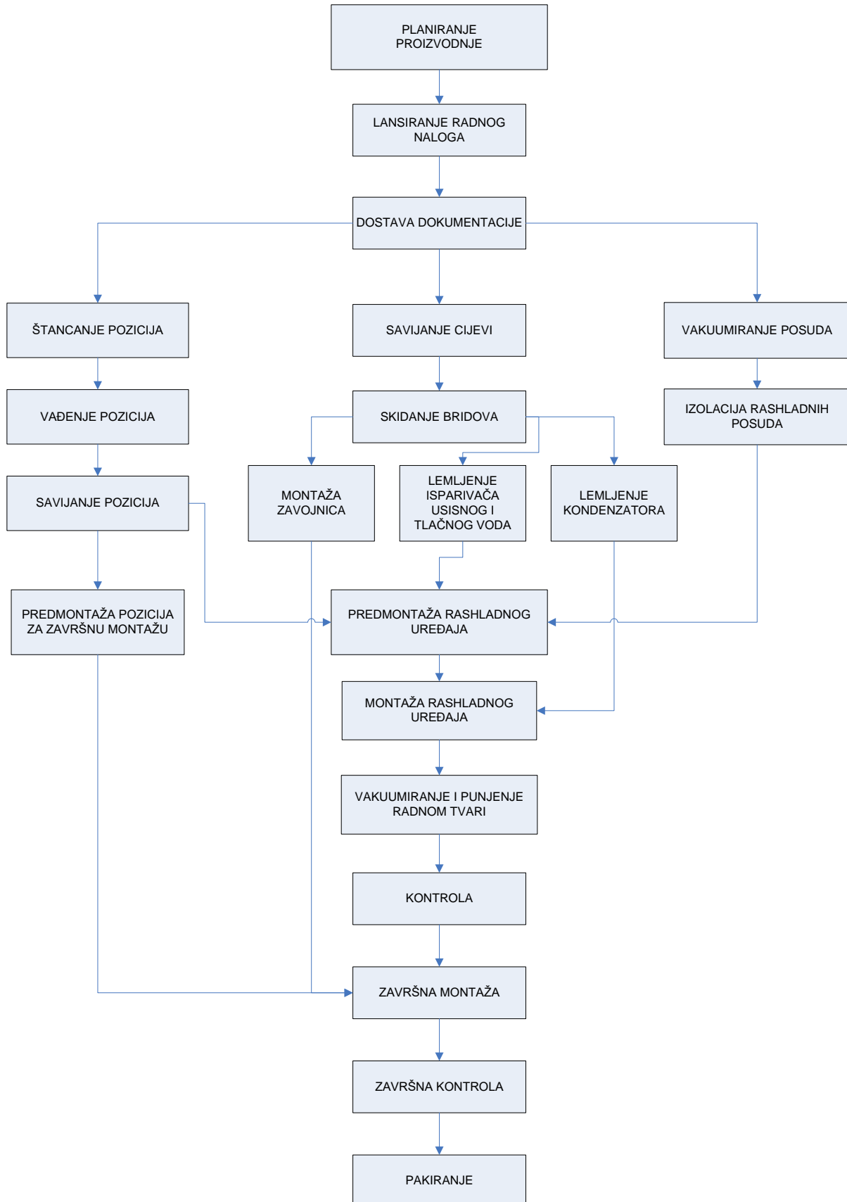
Slika 13. Dijagram toka proizvodnog procesa [10]
