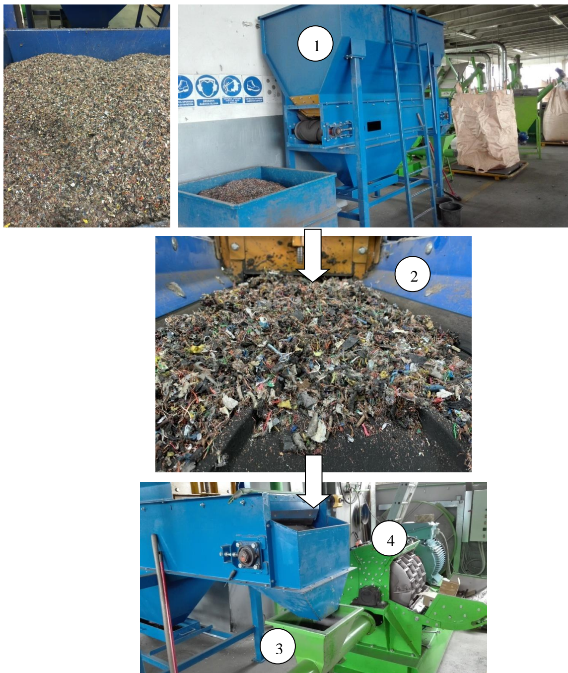
Slika 32. Ulaz materijala na liniji za separaciju
