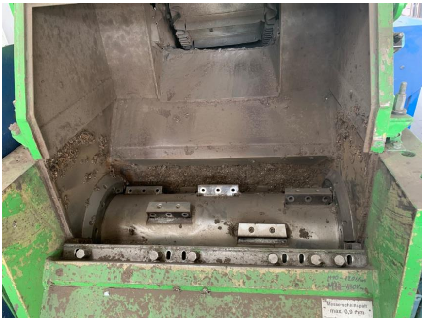
Slika 22. Unutrašnjost usitnjivača, noževi
