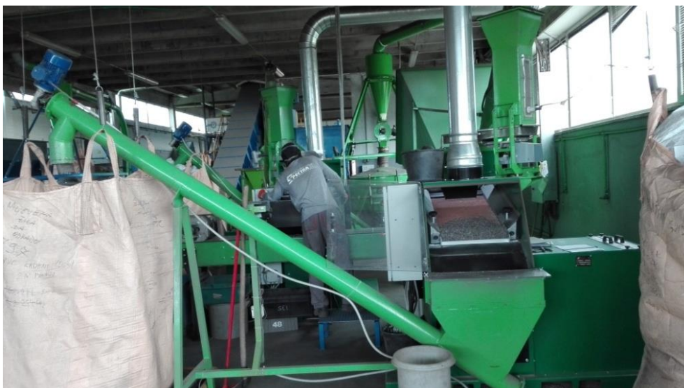
Slika 41. Pužni transporter za polimerni materijal
