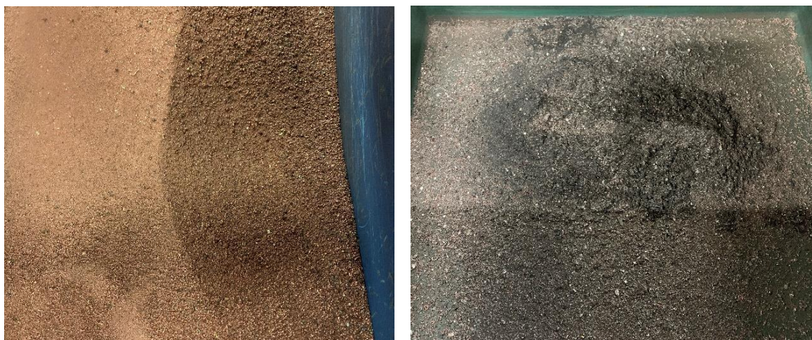
Slika 43. Izlazna frakcija bakra i izlazna frakcija čelika
