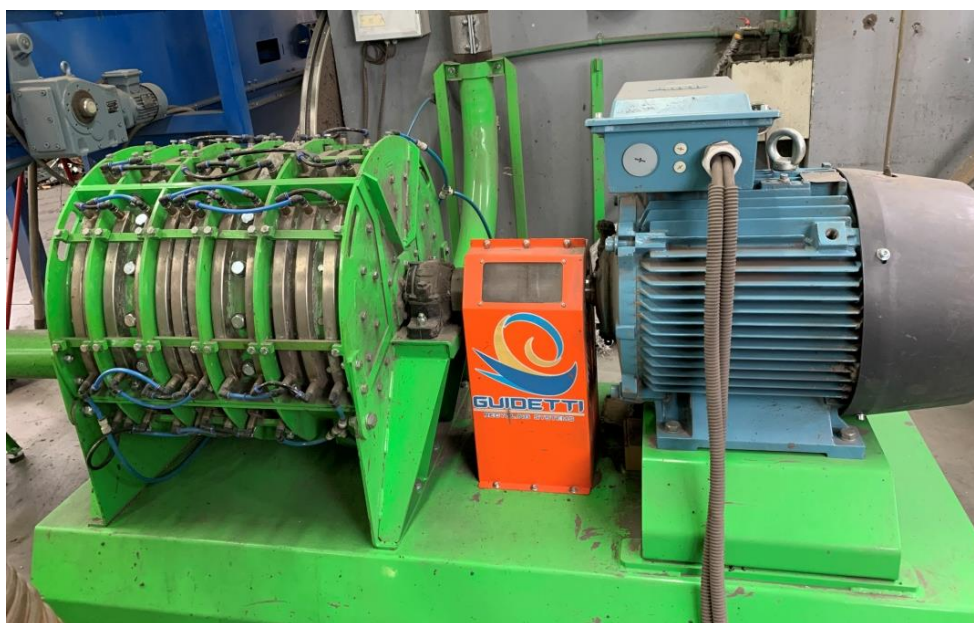
Slika 35. Granulator i elektromotor
