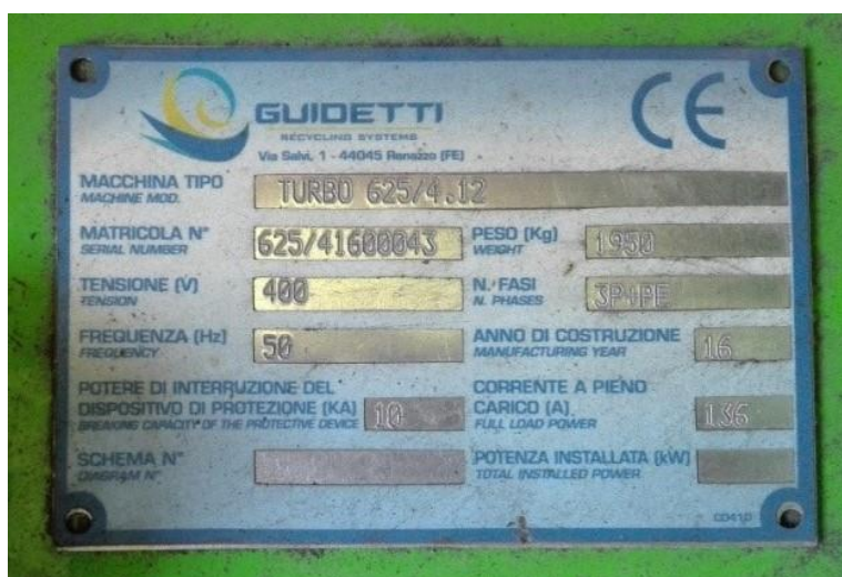
Slika 34. Tehničke karakteristike granulatora
