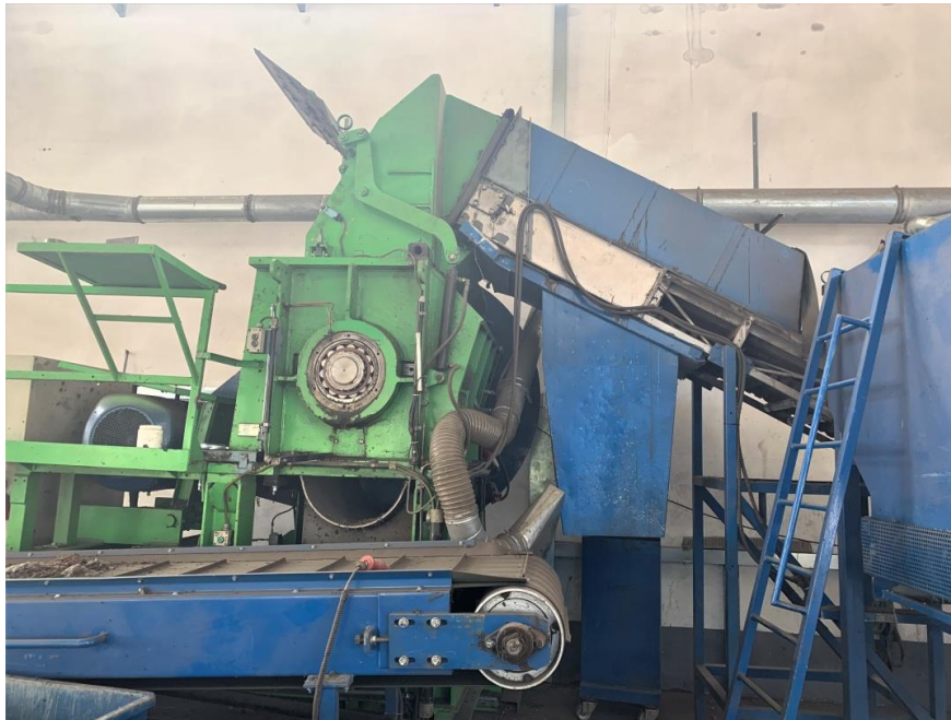
Slika 21. Usitnjivač proizvođača MeWa tip UG 1000
