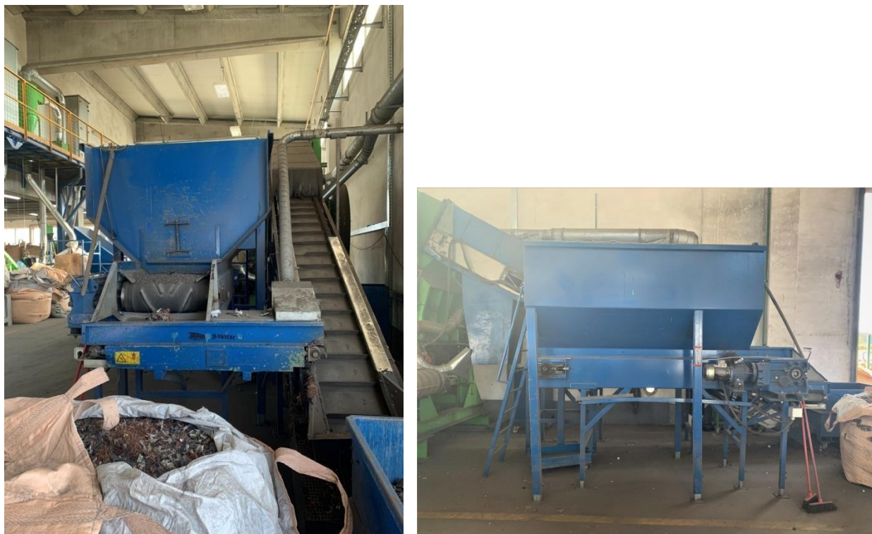
Slika 20. Usipni koš i uzlazna pokretna traka
