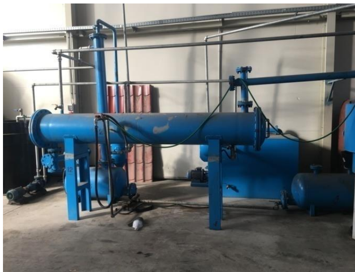
Slika 50. Uređaj za kondenzaciju
