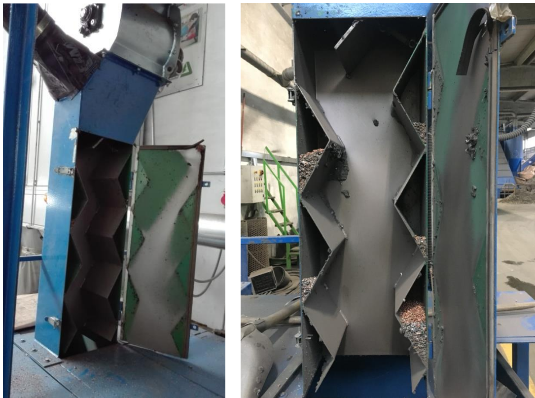
Slika 26. Unutrašnjost zračnog separatora tipa „cik-cak”
