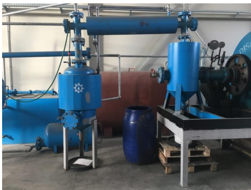
Slika 49. Separatori i cijev za hlađenje
