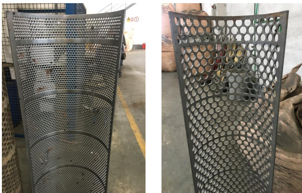
Slika 23. Varijabilna sita od 10 mm i 30 mm
