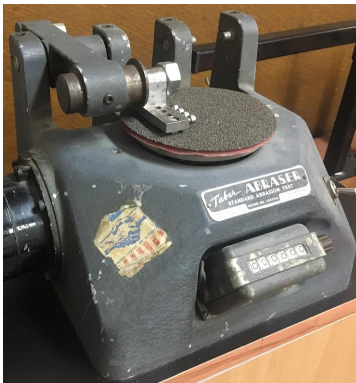
Slika 23. Uređaj za ispitivanje otpornosti na abrazijsko trošenje
