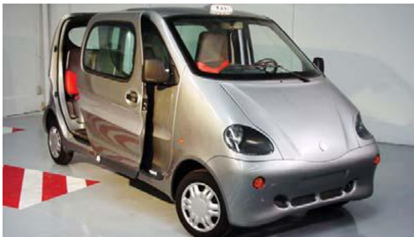
Slika 6. Hibridno vozilo CityCat na pogon komprimiranim zrakom. [2]
