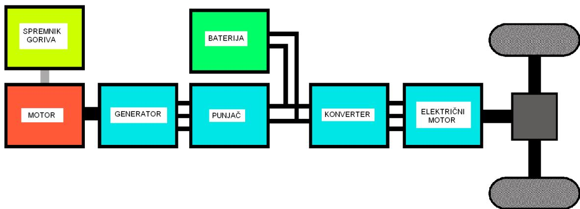
Slika 3. Shematski prikaz serijske izvedbe hibridnog pogona
