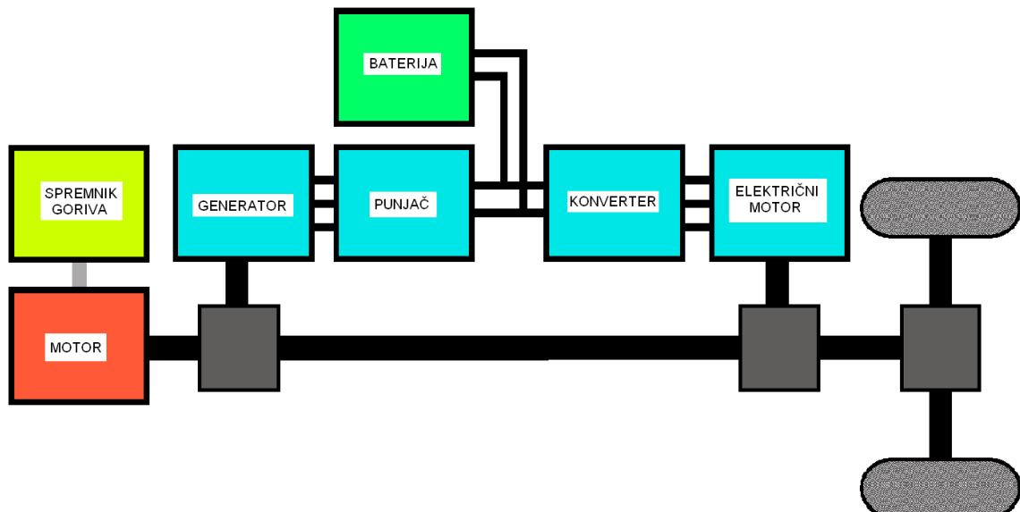
Slika 5. Shematski prikaz serijsko-paralelne izvedbe hibridnog pogona
