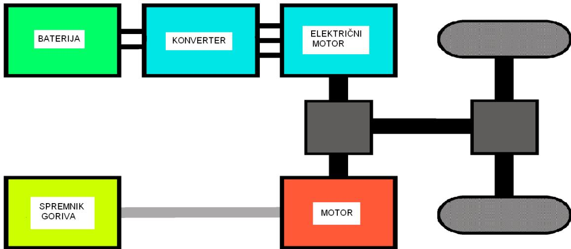
Slika 4. Shematski prikaz paralelne izvedbe hibridnog pogona
