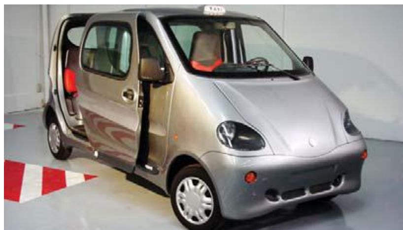
Slika 6. Hibridno vozilo CityCat na pogon komprimiranim zrakom. [2]
