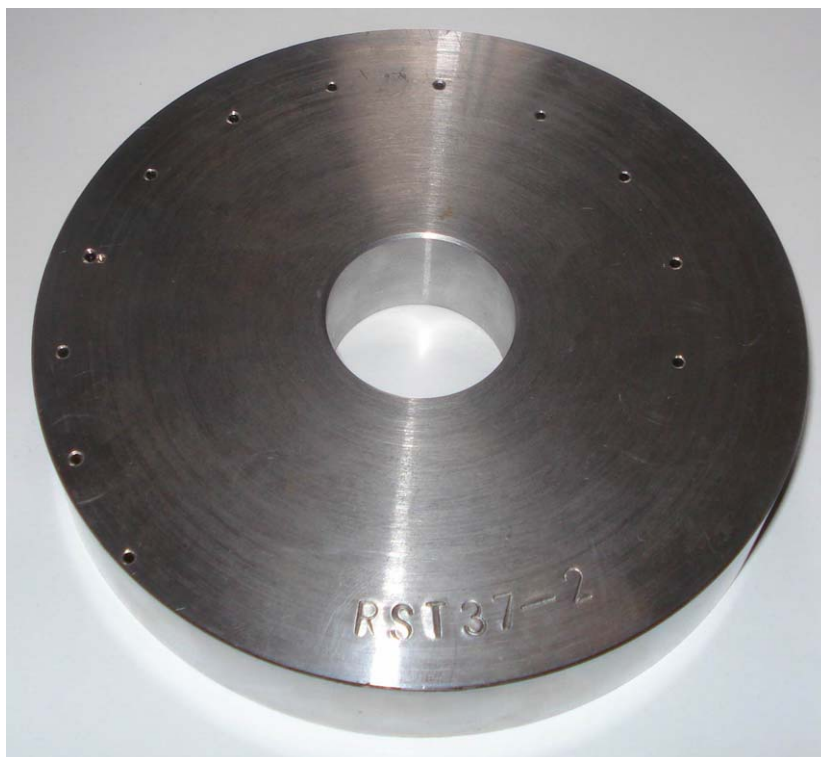
Slika 2.4. Izrađeni etalon Ketos Ring
