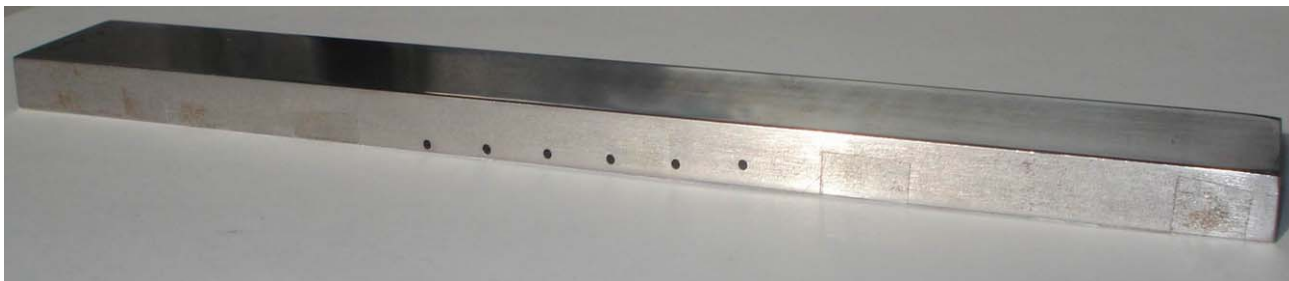
Slika 2.3. Izrađeni etalon Test Bar
