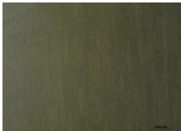
Slika 50. Neoštećena površina uzorka čelika AISI 316L nakon 192 h ispitivanja u 3,5 % otopini NaCl
