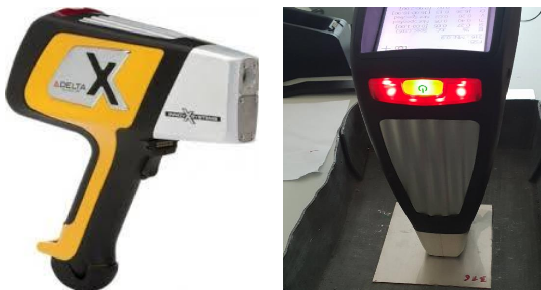
Slika 29. Uređaj XRF – Olympus i prikaz provedbe ispitivanja na čeliku AISI 316 L
