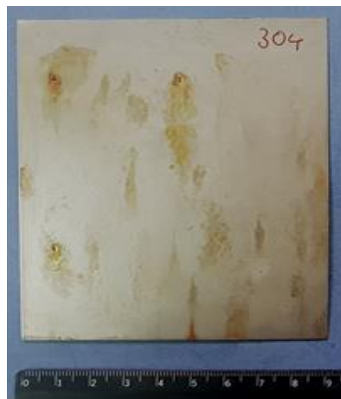
Nakon uklanjanja korozivnih produkata
