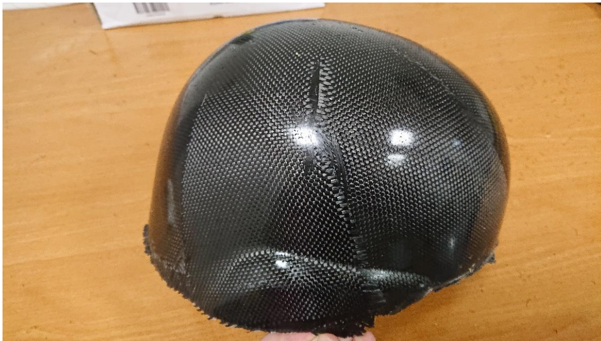
Slika 68. Treća izrađena kaciga, zadovoljavajuće kvalitete
