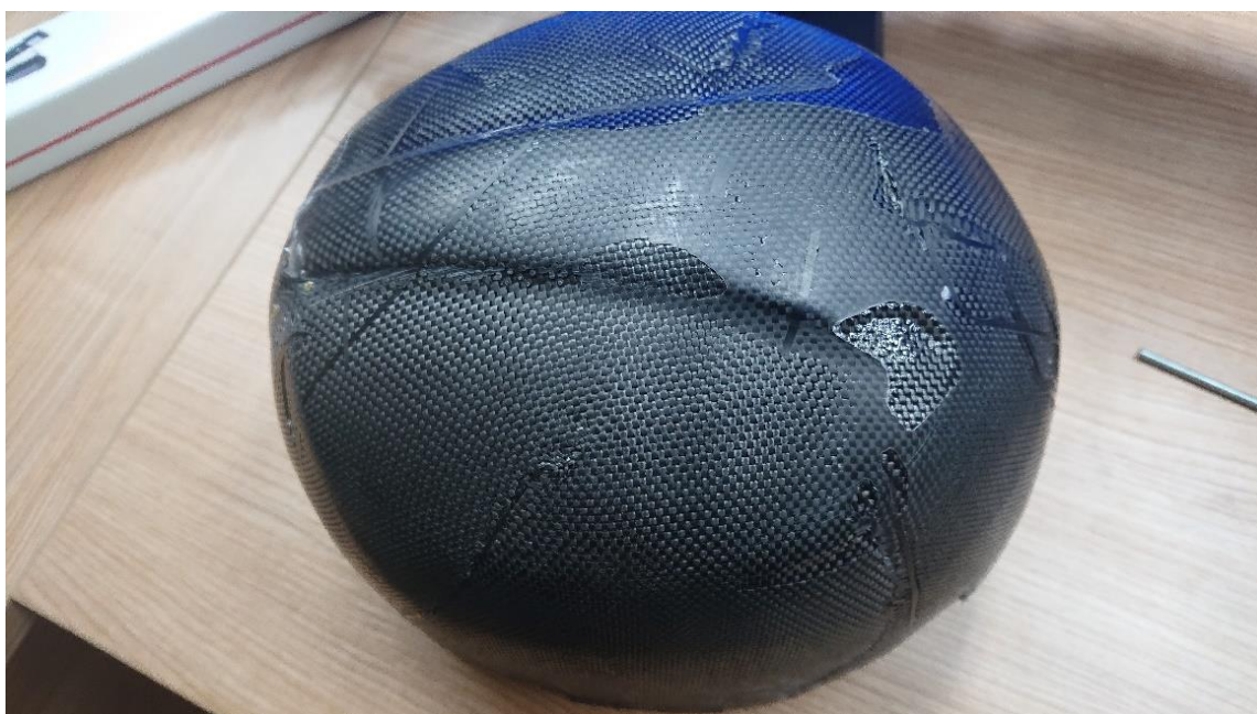
Slika 67. Druga izrađena kaciga, oštećenja uslijed nestvrdnutosti smole
