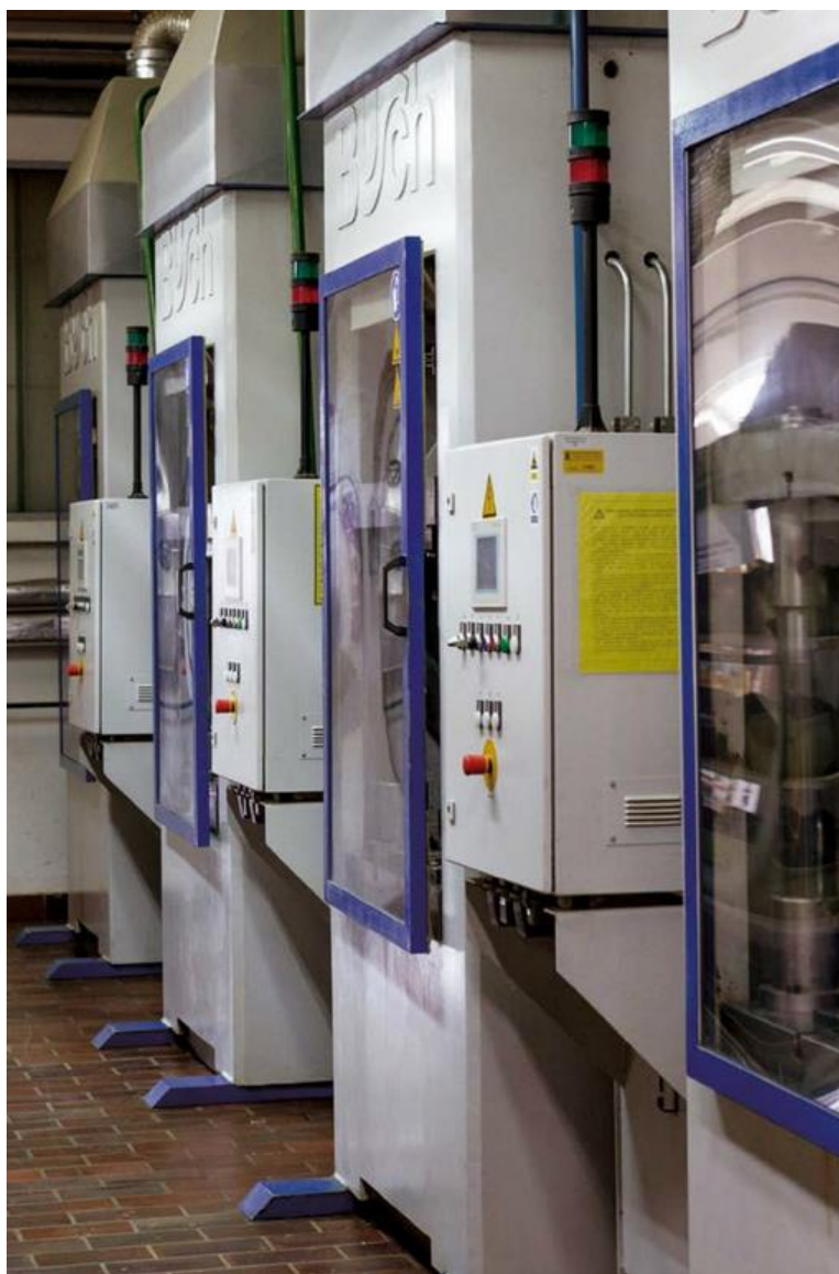
Slika 22. Strojevi za prešanje kaciga [7]
