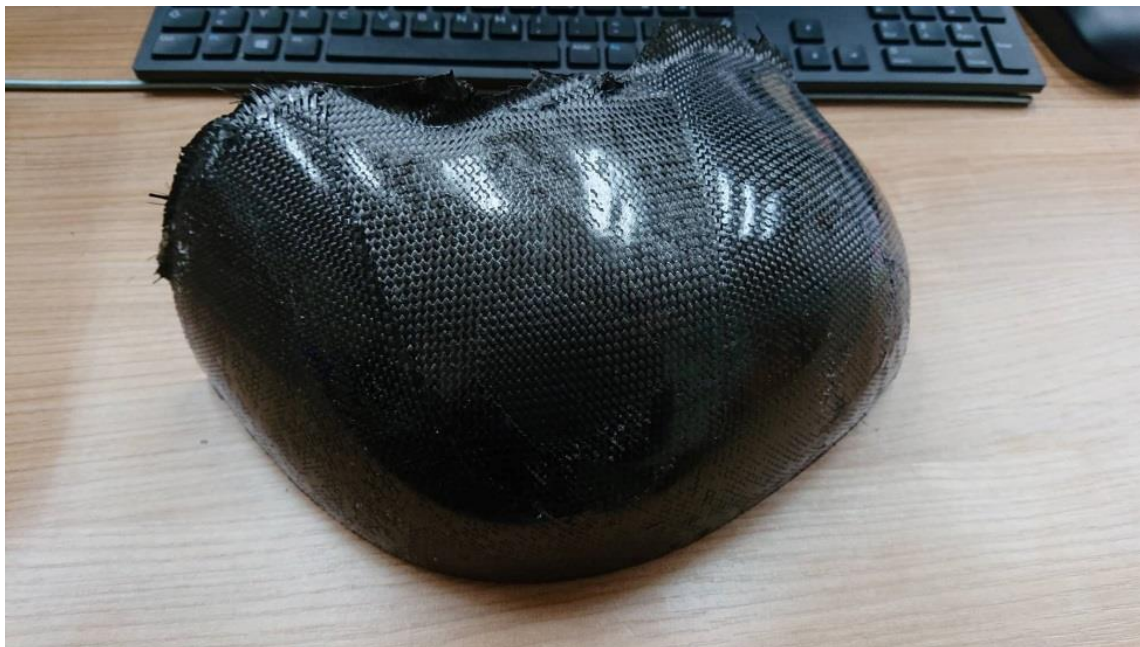
Slika 66. Prva izrađena kaciga, oštećena pri vađenju iz kalupa
