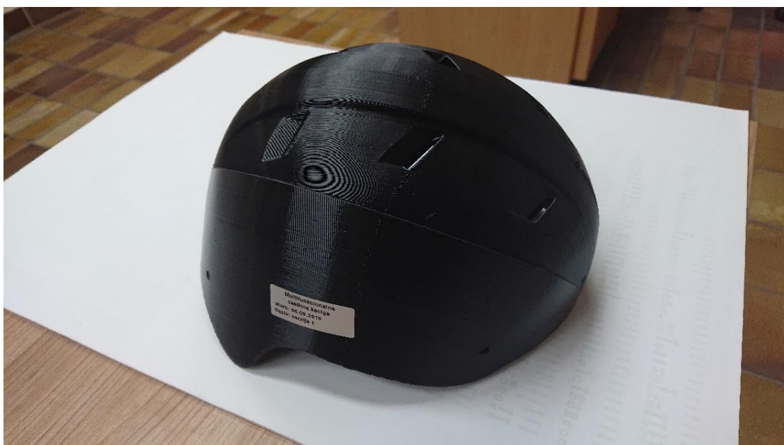
Slika 54. Crna kaciga tiskana postupkom LPD
