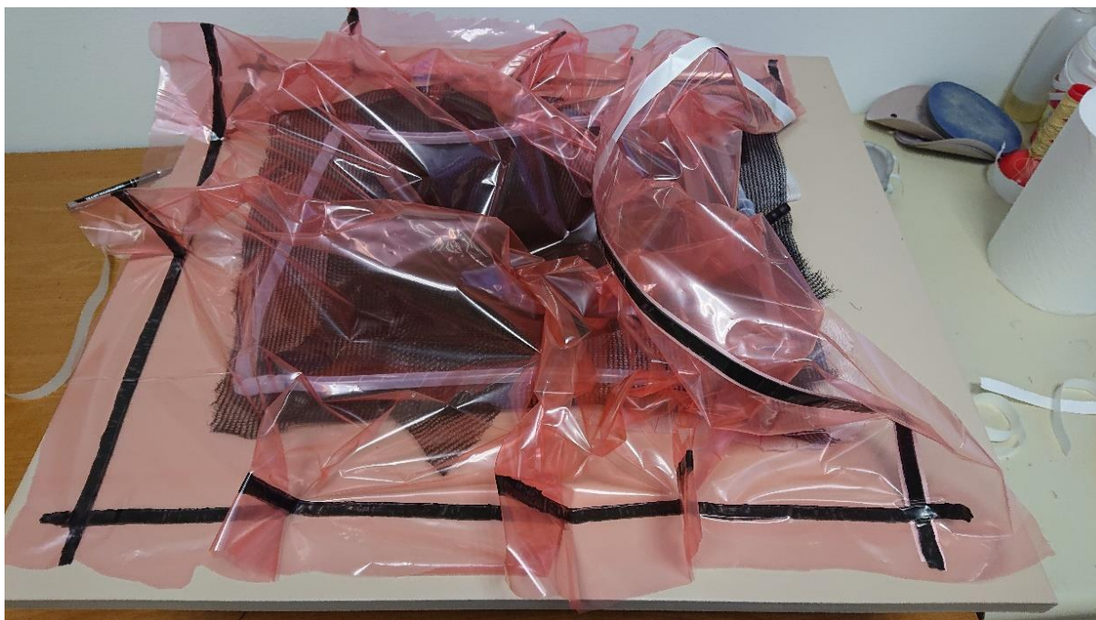
Slika 64. Kalup spreman za postupak vakuumske infuzije
