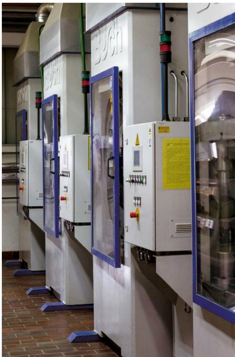
Slika 22. Strojevi za prešanje kaciga [7]
