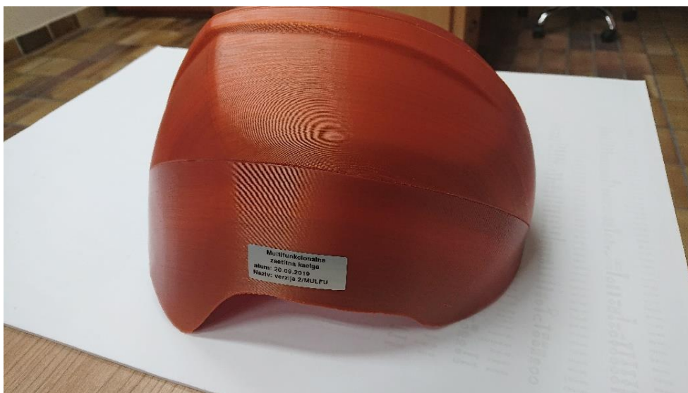
Slika 53. Kaciga tiskana postupkom LPD
