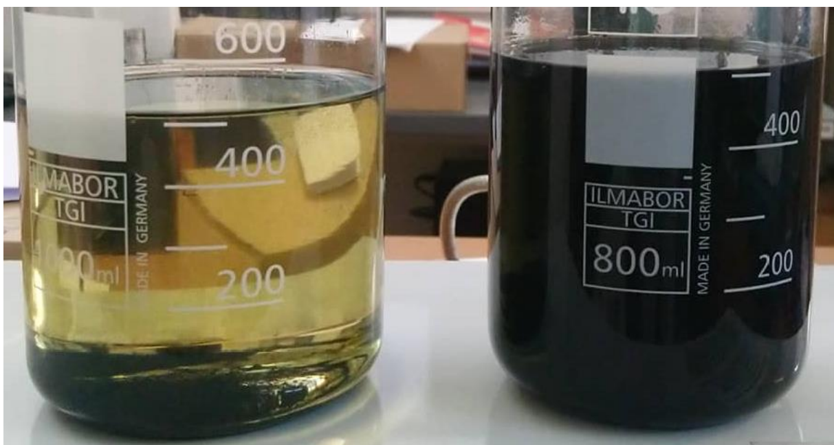
Slika 12. Lijevo prikazan uzorak 3 prije postupka homogenizacije i desno nakon postupka homogenizacije
