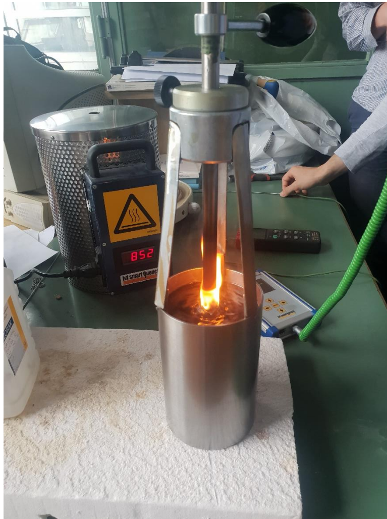
Slika 19. Mjerna proba uronjena u ispitni uzorak (sredstvo za gašenje)
