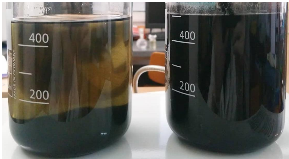
Slika 13. Lijevo prikazan uzorak 4 prije postupka homogenizacije i desno nakon postupka homogenizacije
