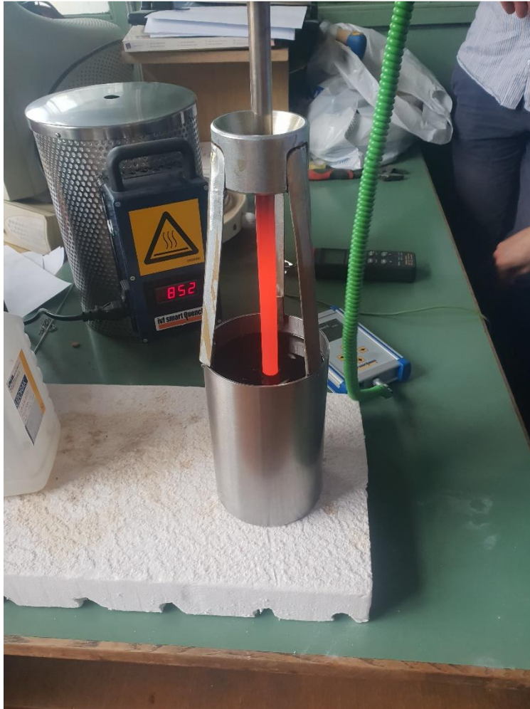
Slika 18. Mjerna proba zagrijana na 850 °C
