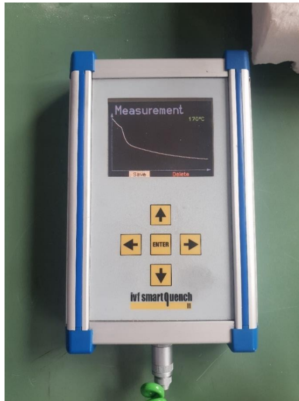
Slika 20. Mjerno-analitičkog sustava IVF smart quench bilježi i snima tijekom krivulje ohlađivanja
