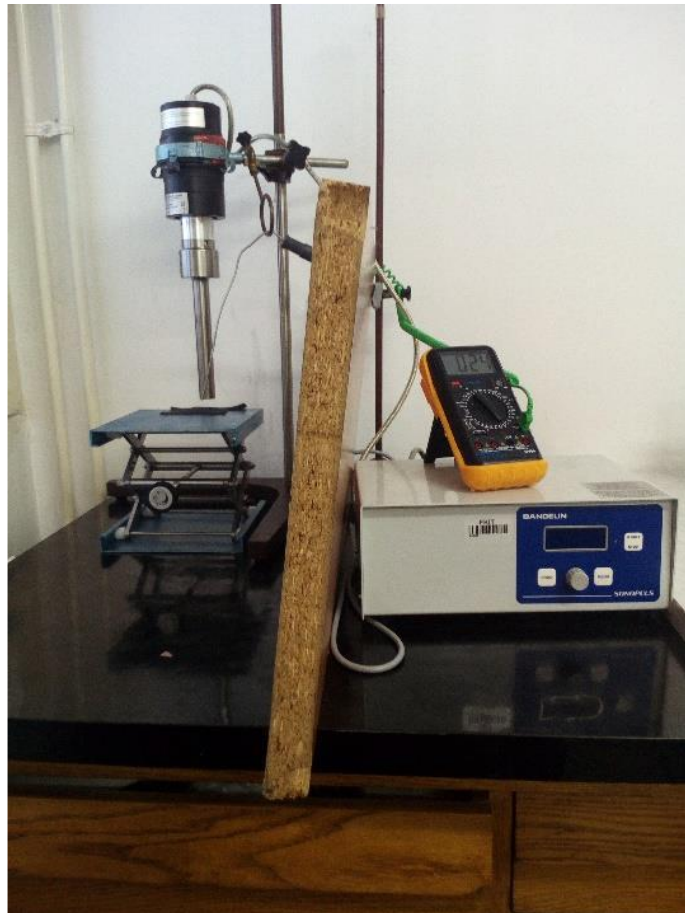
Slika 11. Prikaz aparature za ultrazvučnu homogenizaciju - Sonopuls HD 3400“
