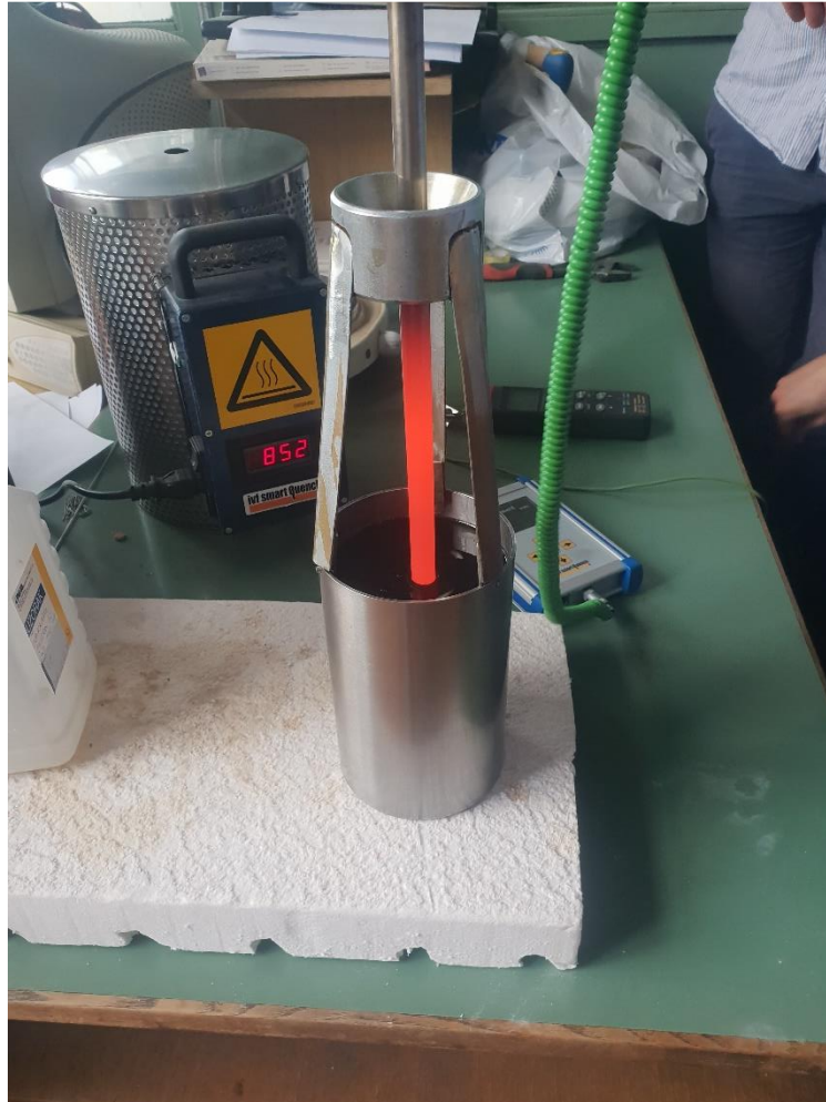
Slika 18. Mjerna proba zagrijana na 850 °C
