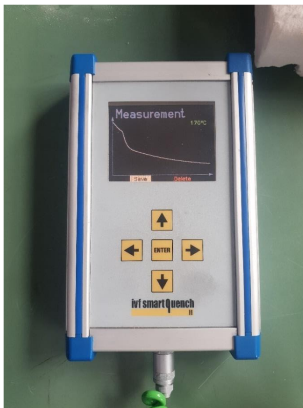
Slika 20. Mjerno-analičkog sustava IVF smart quench bilježi i snima tijekom krivulje ohlađivanja
