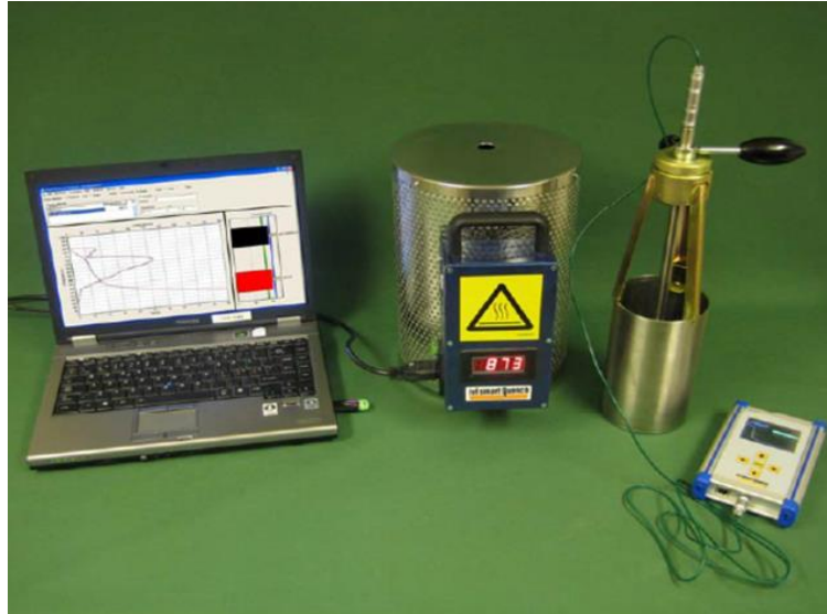
Slika 16. Prikaz mjerno-analičkog sustava IVF Smart Quench za ispitivanje krivulja ohlađivanja prema normi ISO 9950 [19]
