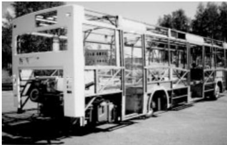
Slika 20. Karoserija autobusa od nehrđajućeg čelika [12]
