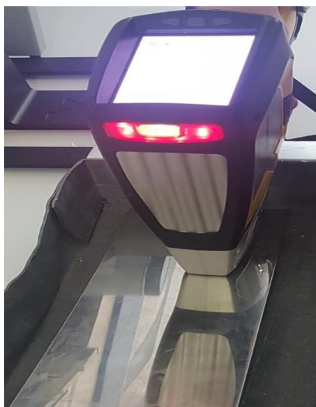
Slika 28. Ispitivanje kemijskog sastava XRF metodom
