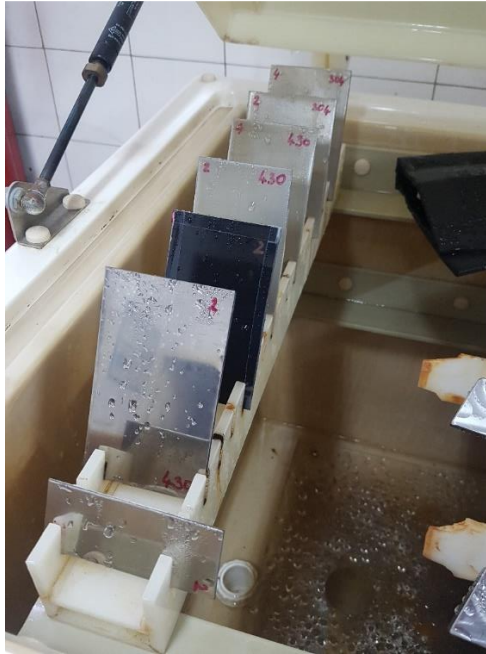
Slika 35. Ispitni uzorci nakon 408 sati ispitivanja u vlažnoj komori
