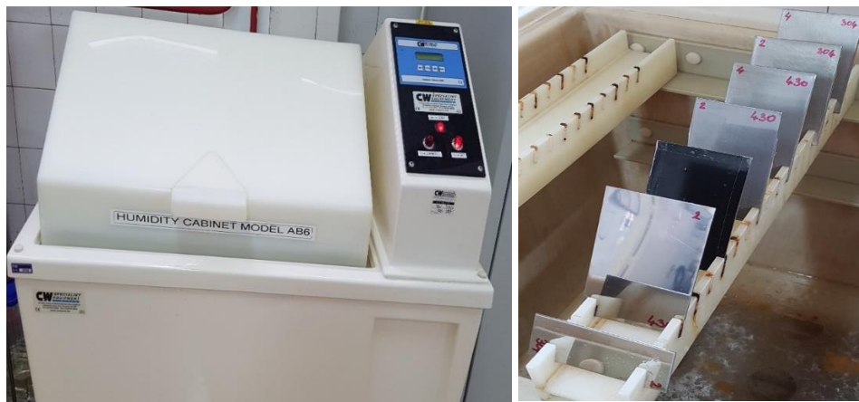
Slika 34. Uzorci u vlažnoj komori tipa Humidity cabinet model AB6
