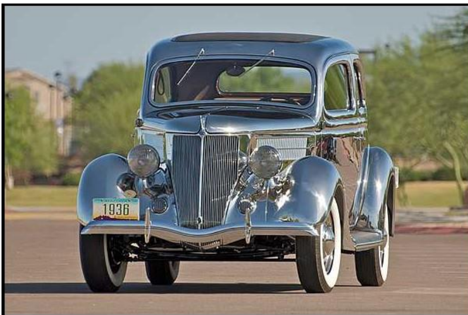
Slika 11. Fordov model iz 1936. izrađen od nehrđajućeg čelika [9]
