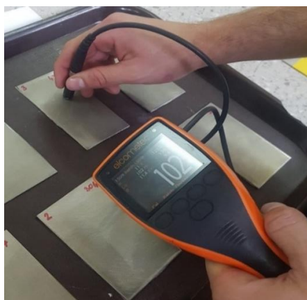
Slika 33. Mjerenje debljine suhog filma (DSF)
