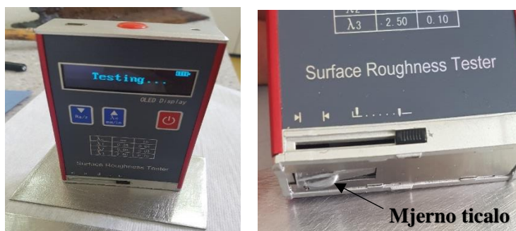
Slika 30. Mjerni uređaj za ispitivanje hrapavosti
