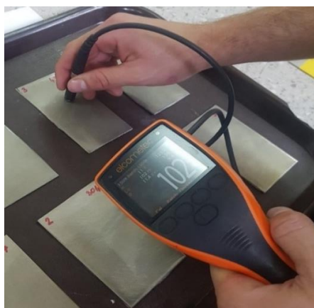
Slika 33. Mjerenje debljine suhog filma (DSF)
