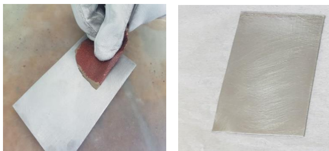
Slika 29. Postupak ručnog brušenja uzorka te obrađeni uzorak
