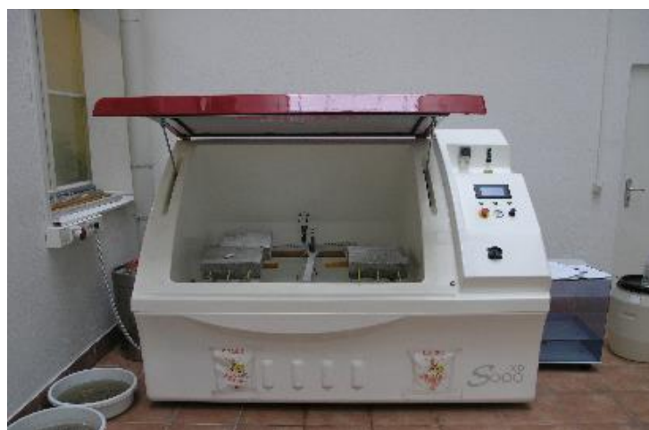
Slika 22. Slana komora za ubrzano korozijsko ispitivanje [21]
