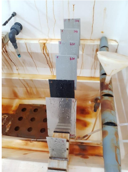
Slika 37. Ispitni uzorci nakon 408 sati ispitivanja u slanoj komori
