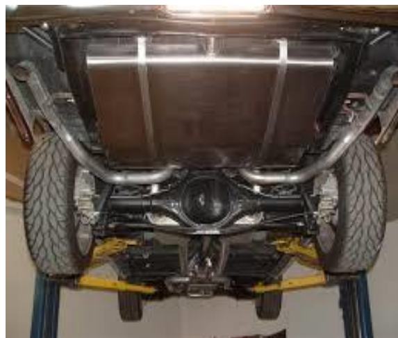
Slika 17. Spremnik goriva od nehrđajućeg čelika [14]
