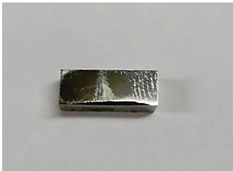
Slika 6.2. Izrezani uzorak WC-15Co
