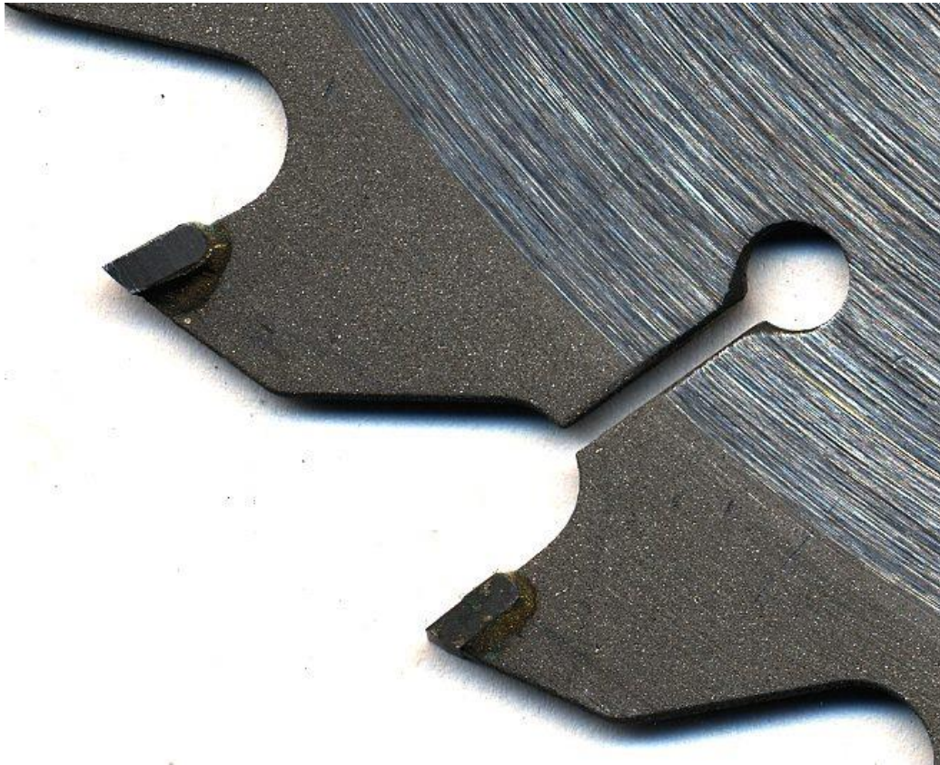
Slika 3.5. Rezne pločice pile za rezanje [19]
