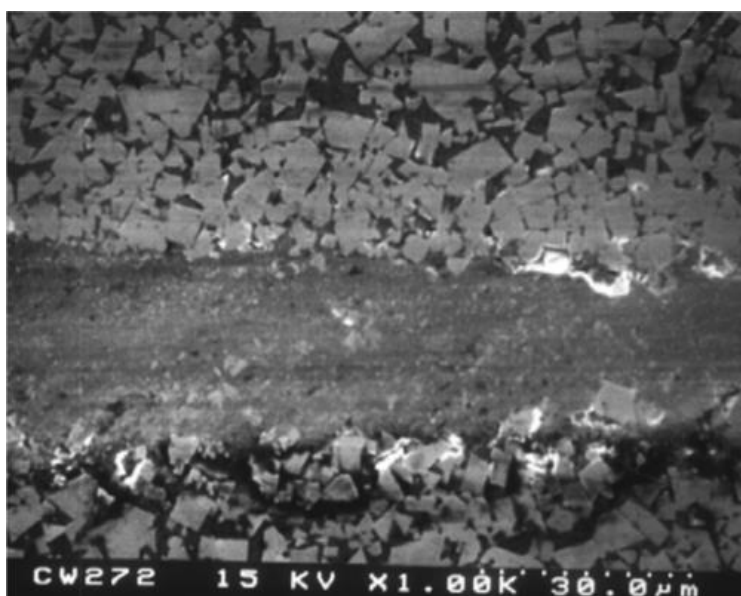
Slika 4.8. Površina WC-Co tvrdog metala s 20% Co nakon provednog testa brazdanja [31]
