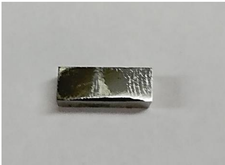
Slika 6.2. Izrezani uzorak WC-15Co
