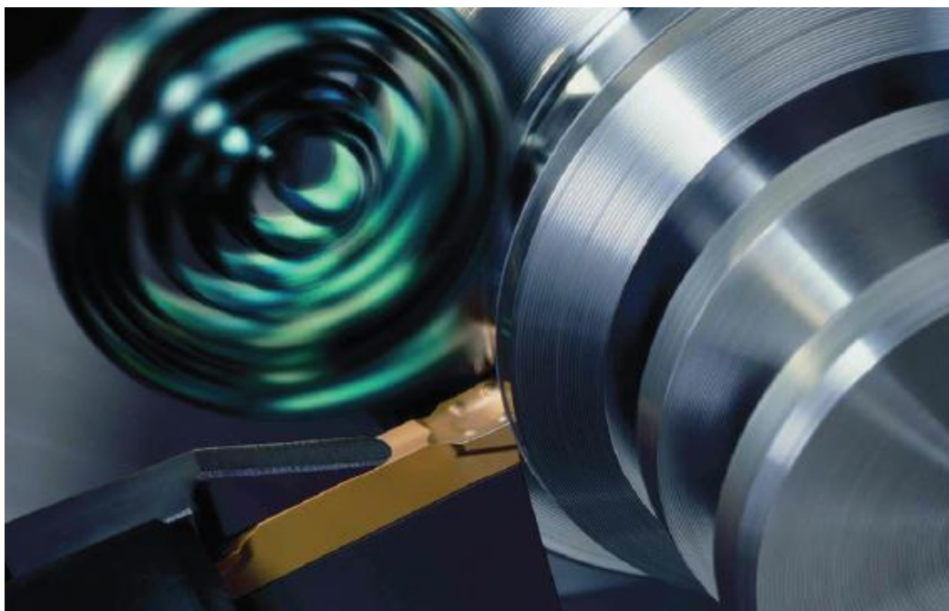
Slika 3.3. Pločica od tvrdog metala noža za tokarenje [17]
