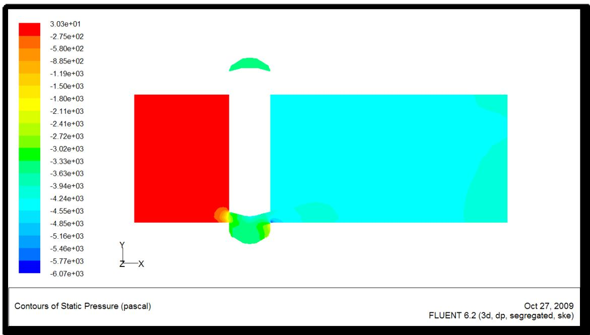
**Slika 4.21 Polje tlaka na ravnini simetrije za  $h=20\text{mm}$**
