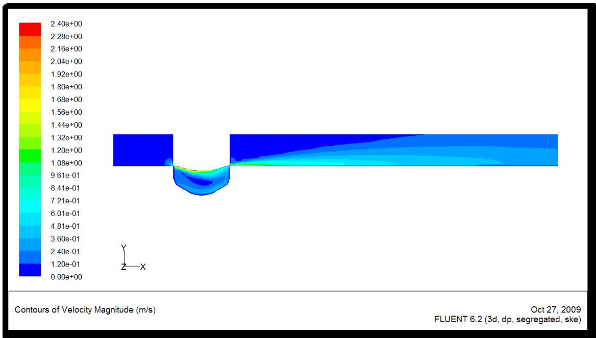
Slika 4.40 Polje brzina na ravnini simetrije u blizini procjepa za  $h=1\text{ mm}$
