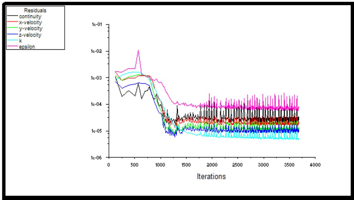
Slika 4.38 Prikaz ponašanja reziduala po iteracijama za  $h=1\text{ mm}$
