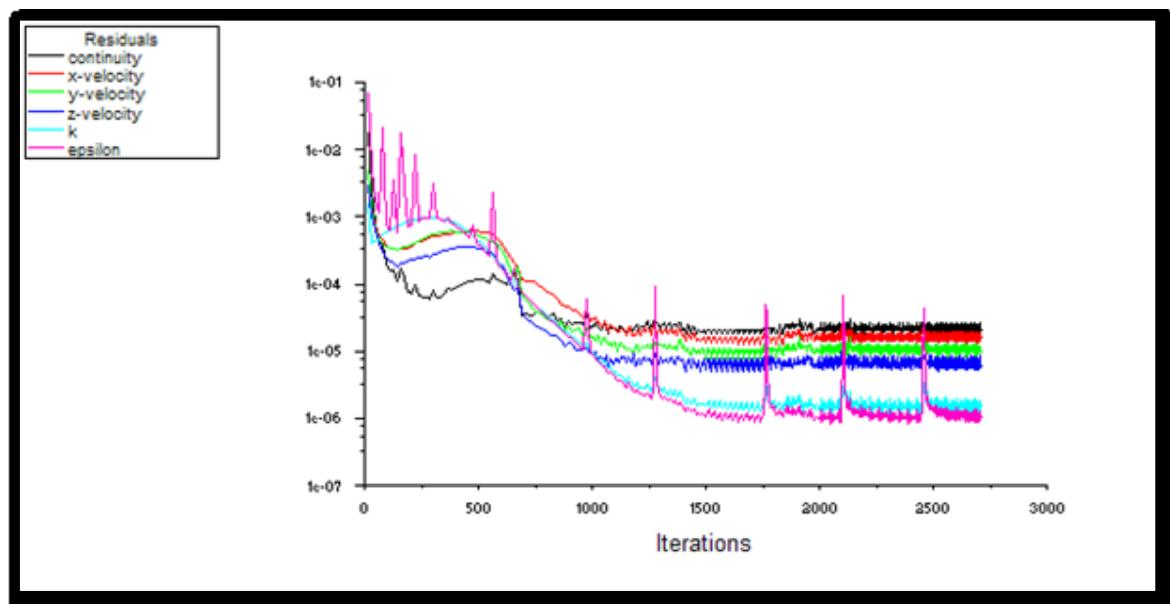
Slika 4.18 Prikaz ponašanja reziduala po iteracijama za  $h=20\text{mm}$
