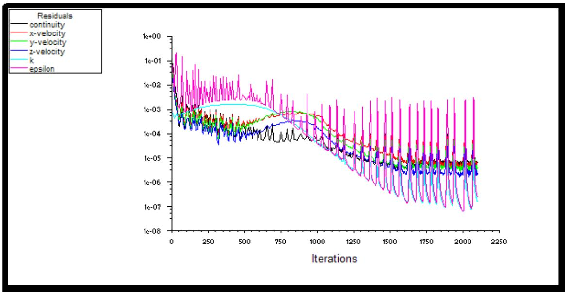
Slika 4.28 Prikaz ponašanja reziduala po iteracijama za  $h=5\text{mm}$
