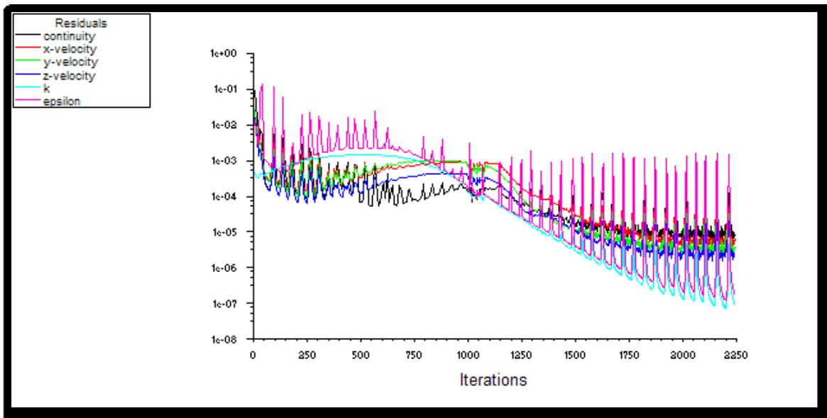
Slika 4.33 Prikaz ponašanja reziduala po iteracijama za  $h=2\text{ mm}$
