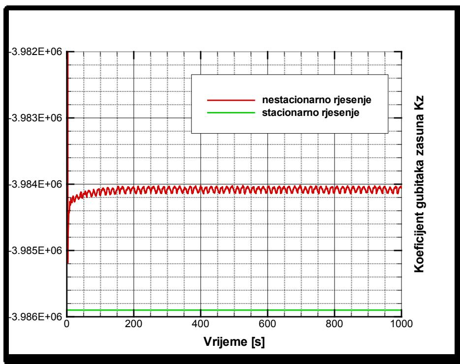
Slika 4.39 Koeficijenti gubitaka stacionarnog i nestacionarnog rješenja  $h=1\text{ mm}$
