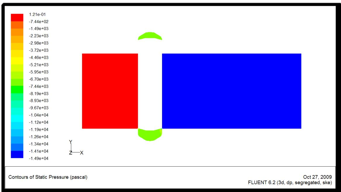
Slika 4.41 Polje tlaka na ravnini simetrije za  $h=1\text{ mm}$
