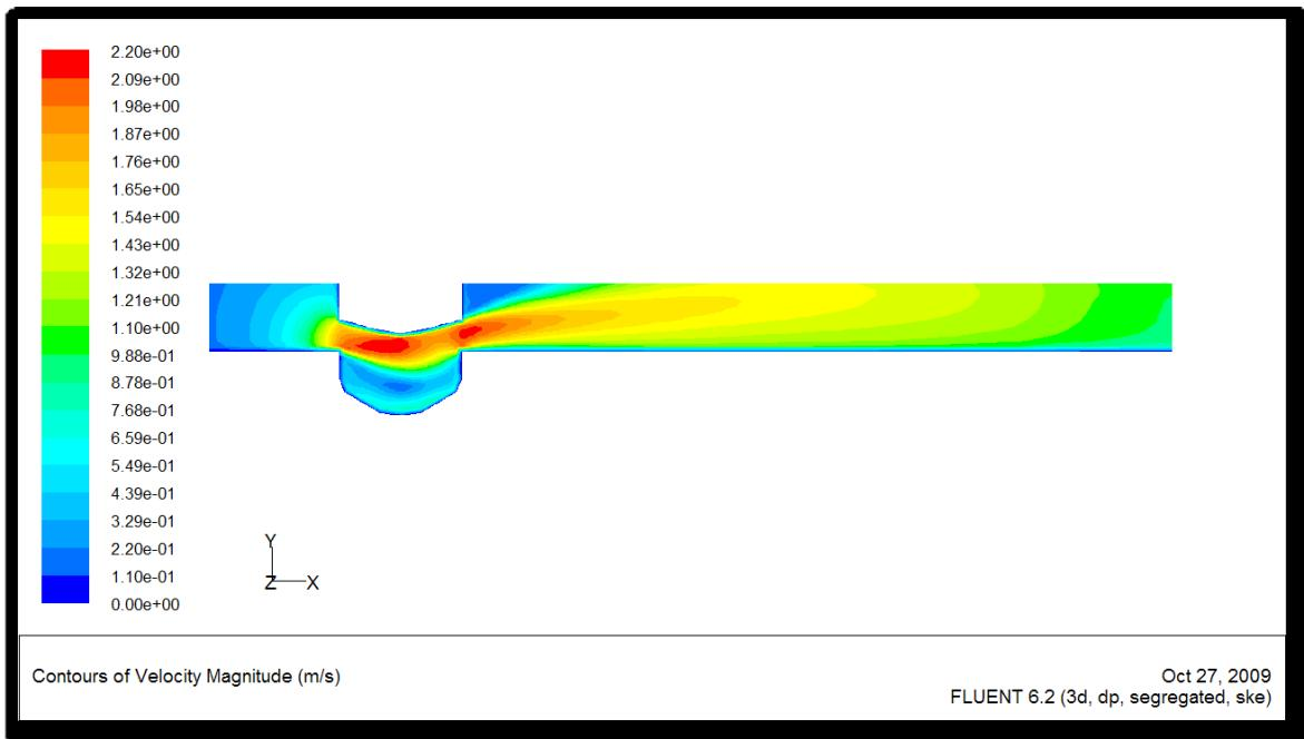
**Slika 4.20 Polje brzina na ravnini simetrije u blizini procjepa za  $h=20\text{mm}$**
