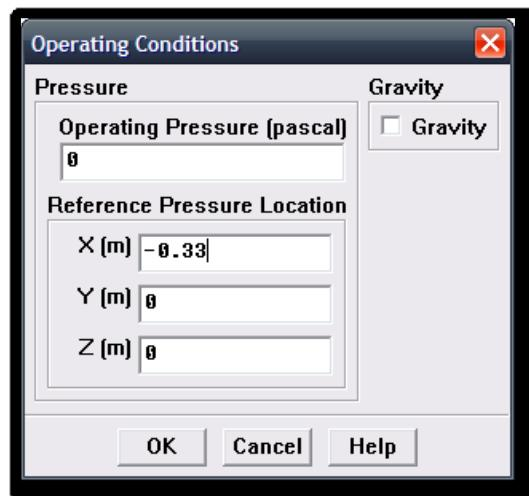
Slika 4.14 Definiranje referentne točke tlaka
