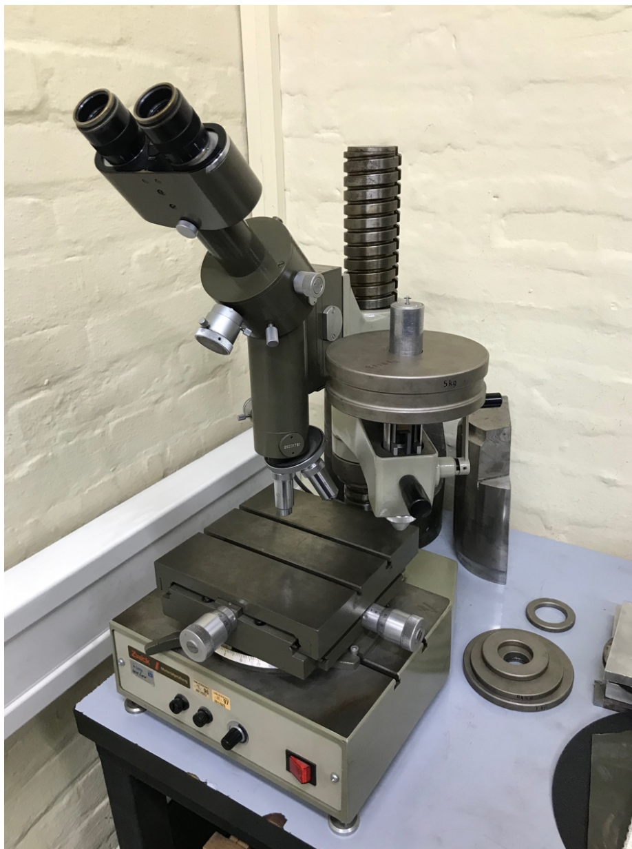
Slika 3. Tvrdomjer proizvođača Zwick
