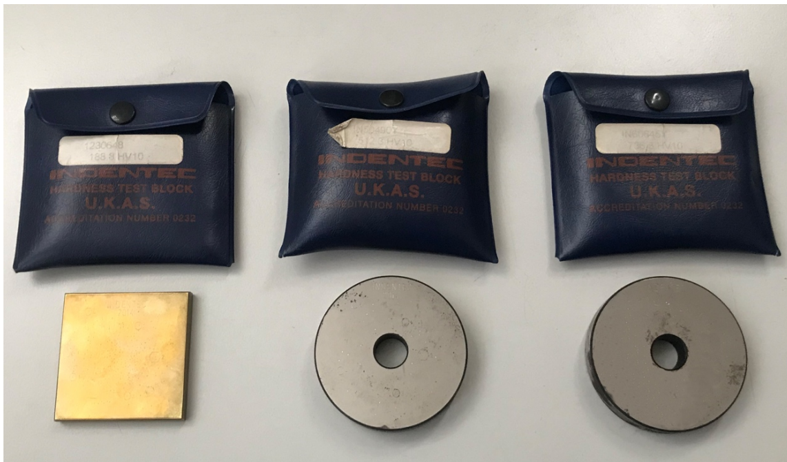
Slika 13. Primarne etalonske pločice: 188,8 HV 10; 512,3 HV 10; 736,3 HV 10
