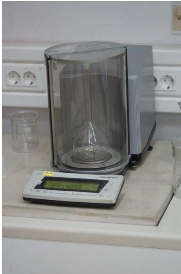
Slika 52. Precizna vaga za mjerenje uzorka
