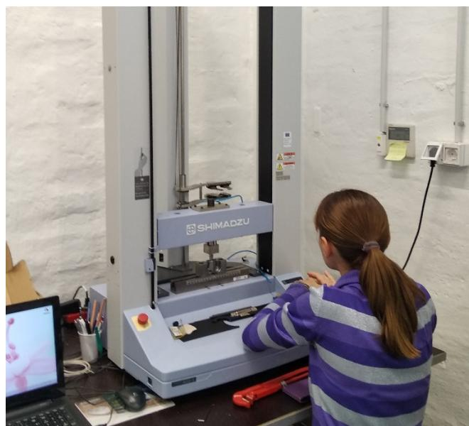
Slika 54. Uređaj za ispitivanje *SHIMADZU AG-X plus*
