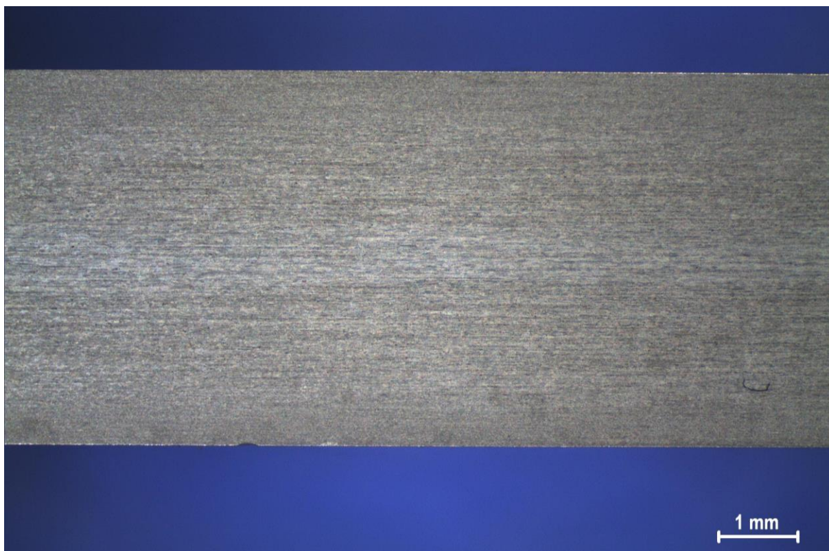
Slika 35 Presjek zida uzorka 1 (legura 5083)
