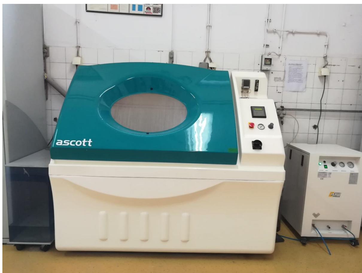
Slika 59 Ispitivanje u slanoj komori tipa Ascott S450
