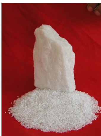
Slika 1 Aluminijev oksid (glinica) za elektrolitičko dobivanje aluminija [3]
