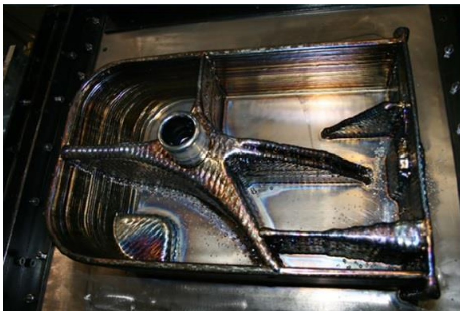
Slika 13 Primjer proizvoda dobivenog WAAM tehnologijom [34]
