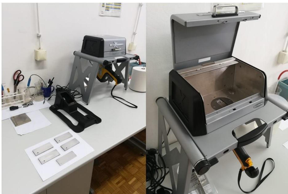
Slika 30 Prikaz XRF analizatora za ispitivanje kemijskog sastava
