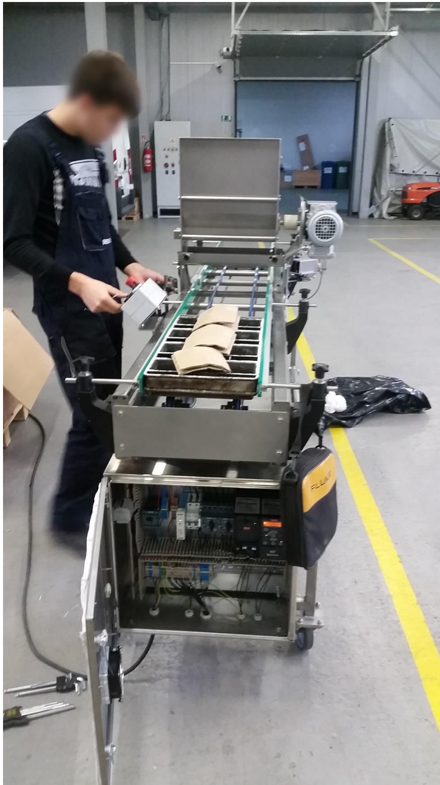
Slika 58. Ispitivanje funkcionalnosti transportnog uređaja
