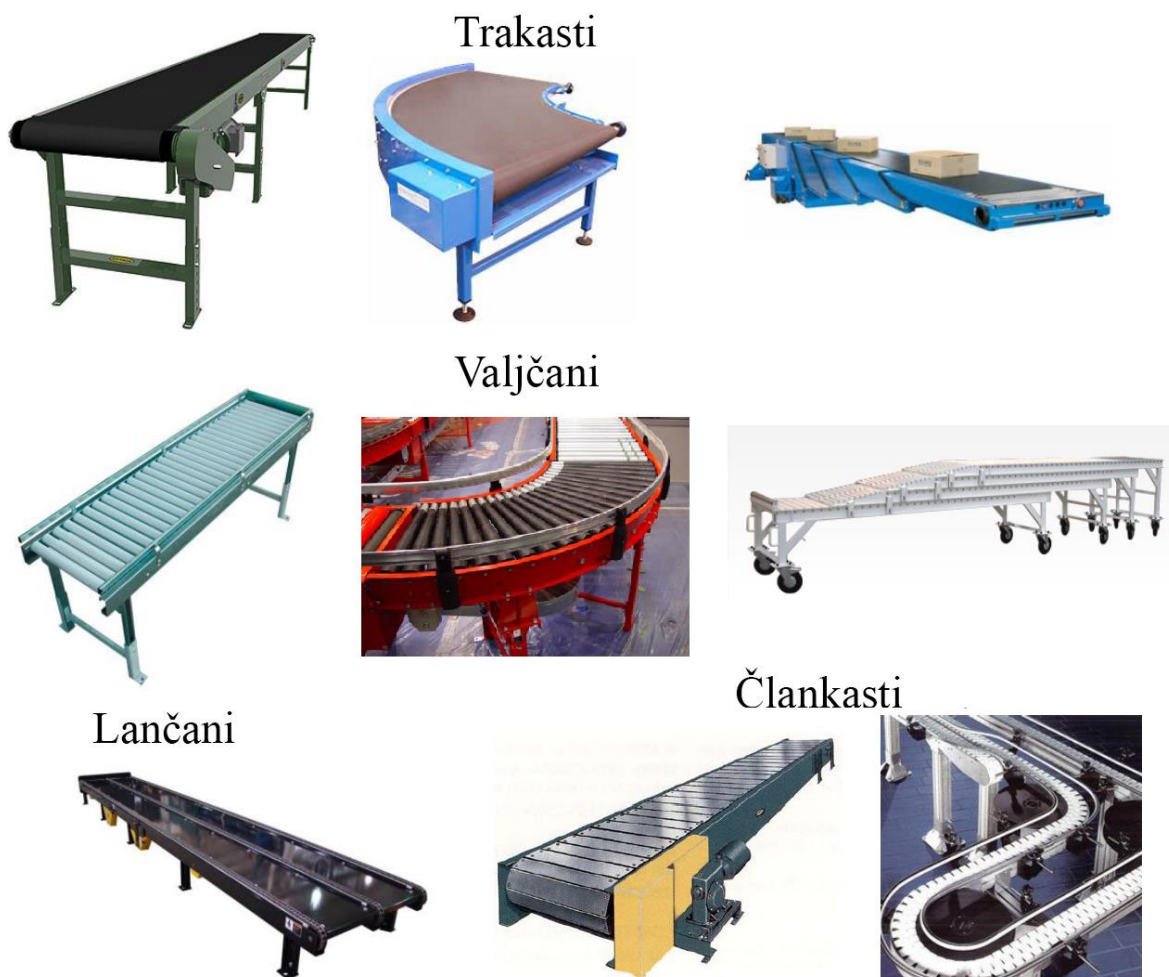
Slika 2. Različite izvedbe osnovnih tipova konvejera za transport komadnog tereta [1]
