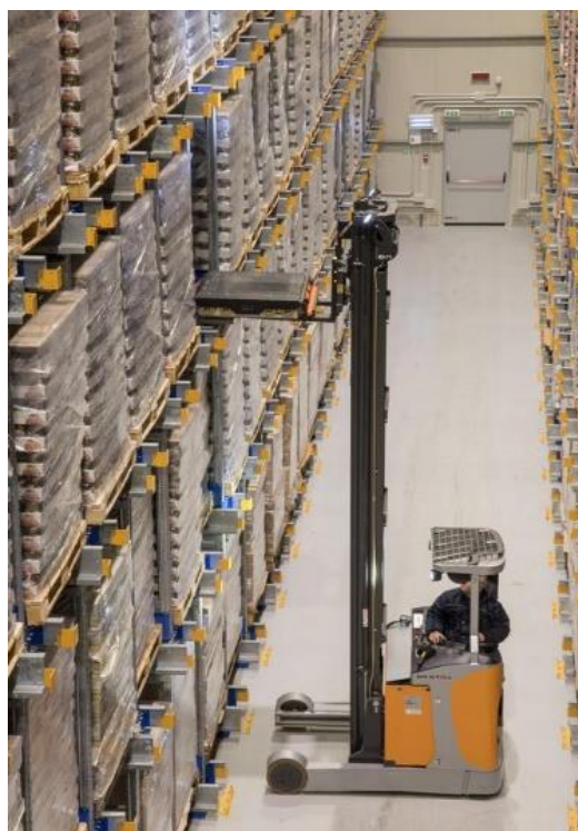
Slika 8. Visokoregalni viličar u suradnji s Radio Shuttle-om [7]
