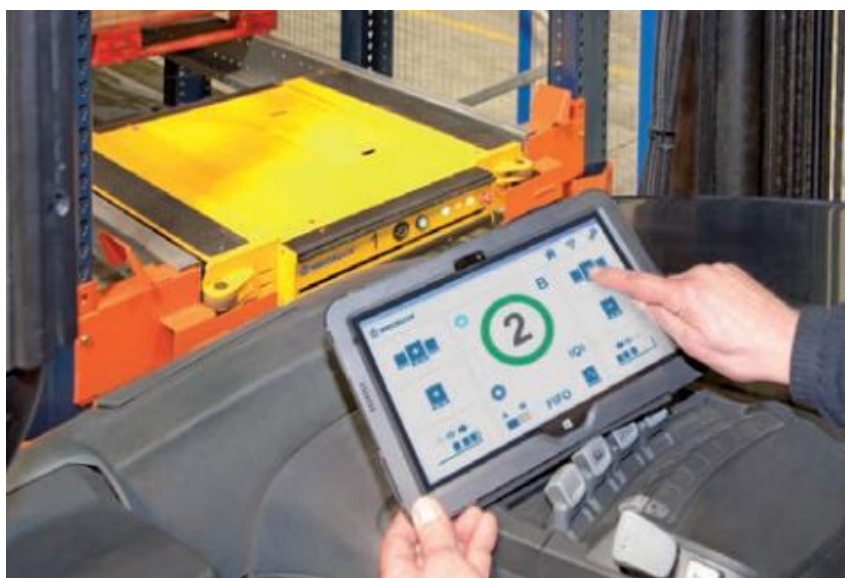
Slika 21. Upravljanje Shuttle-ovima iz kabine viličara [9]
