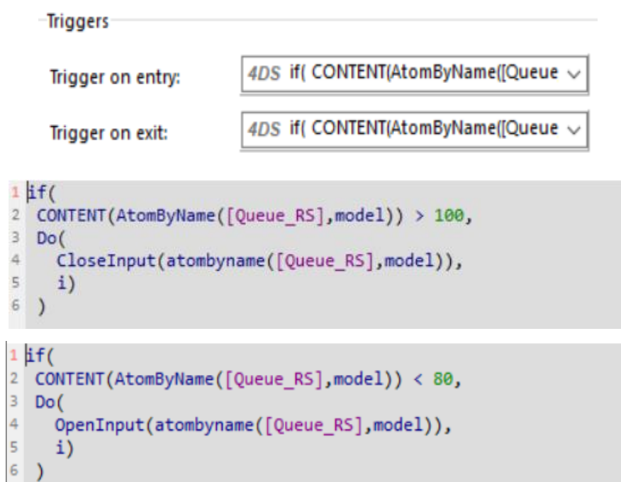
Slika 53. Programiranje zone za odlaganje proizvoda
