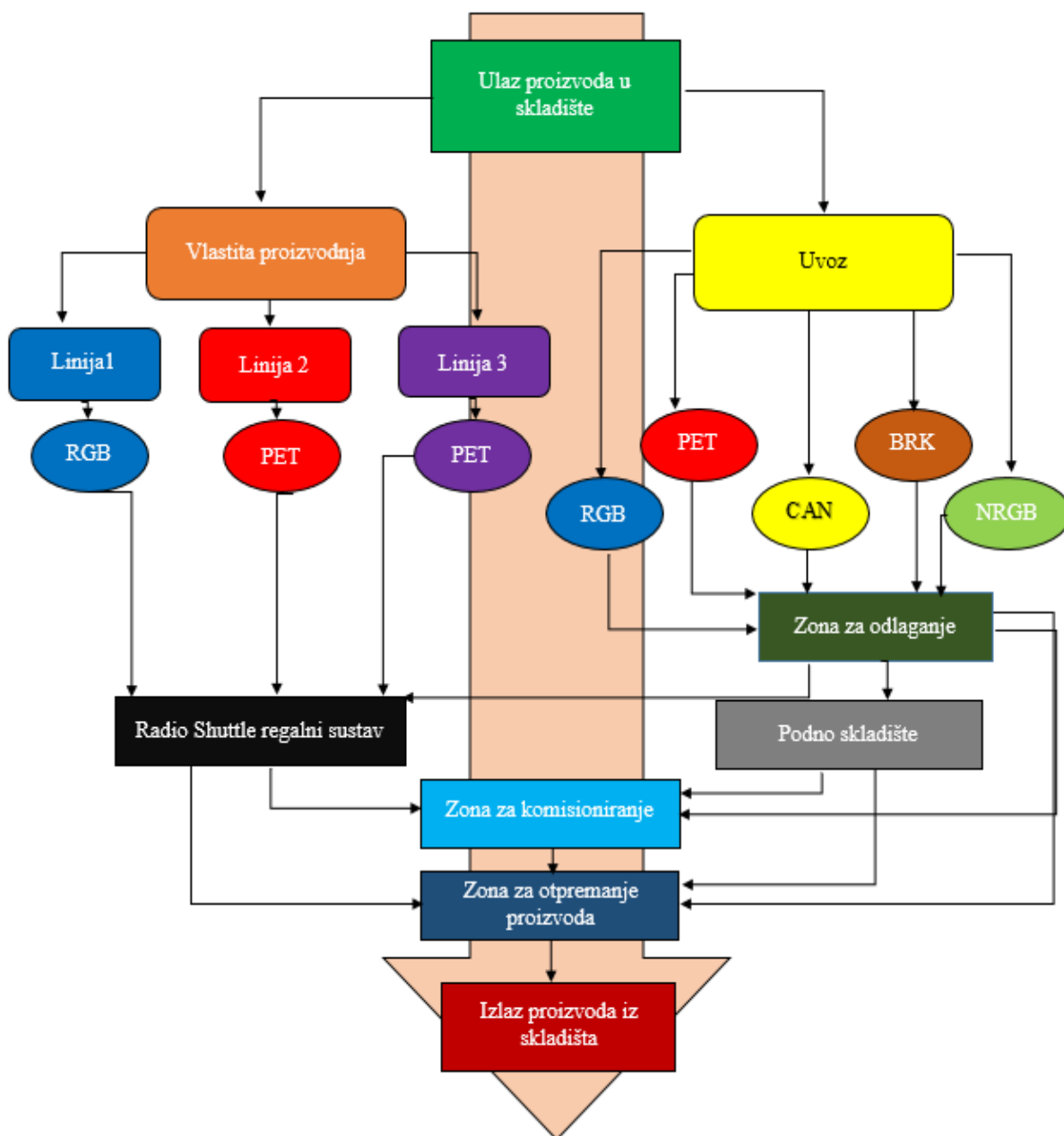
Slika 31. Shematski prikaz toka proizvoda kroz skladišni sustav
