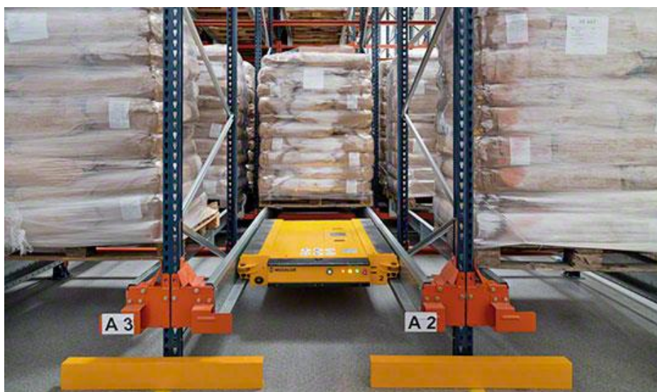
Slika 16. Radio Shuttle unutar staze u regalnom sustavu [9]
