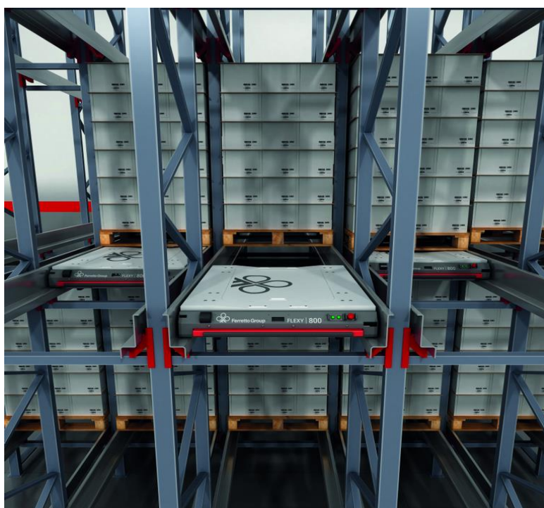
Slika 7. Prikaz Radio Shuttle regalnog sustava [7]
