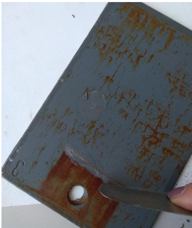
Slika 28. Uklanjanje premaza u području ureza
