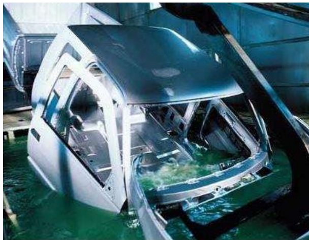
Slika 3. Nanošenje metalne prevlake u autoindustriji [7]
