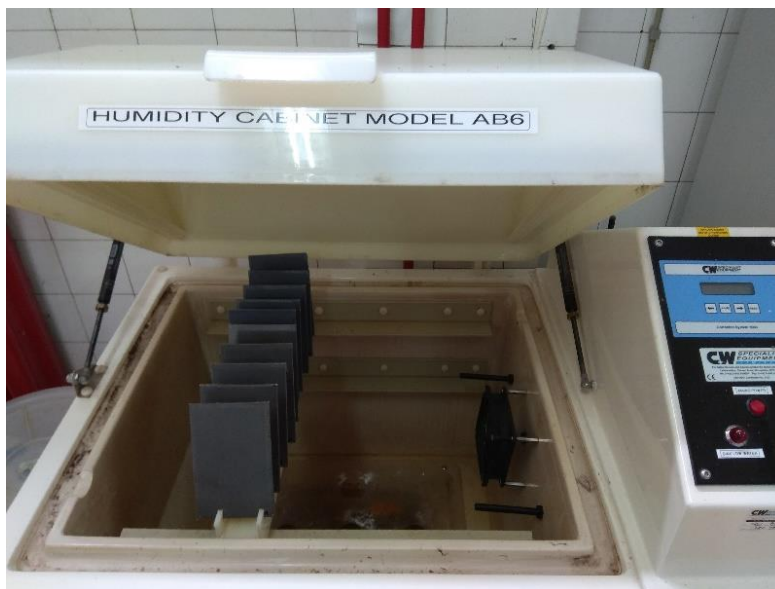
Slika 58. Uzorci premazani s VpCI-386 i Chromos vodenim premazom u vlažnoj komori
