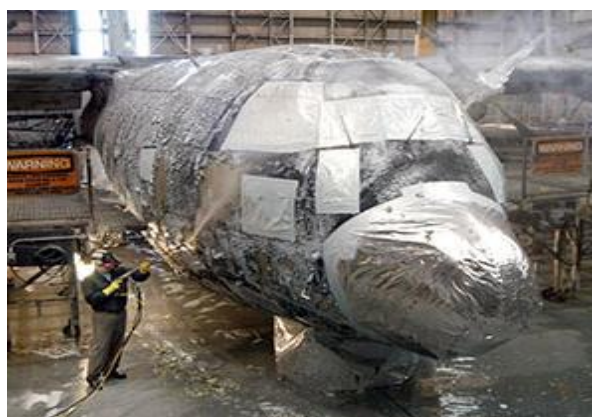
Slika 22. Primjena inhibitora korozije u zrakoplovstvu [25]
