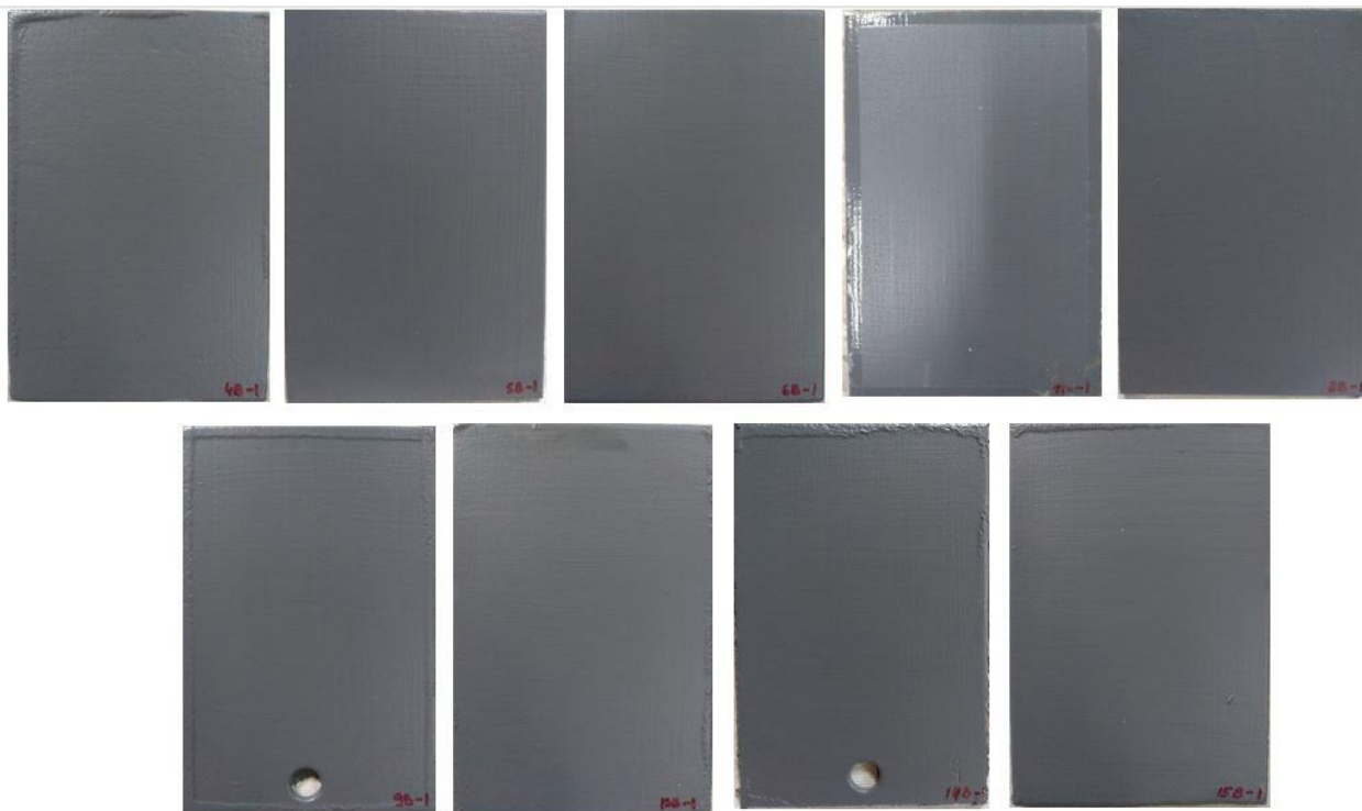
Slika 68. Uzorci premazani s Chromos vodenim premazom (veća koncentracija) prije ispitivanja
