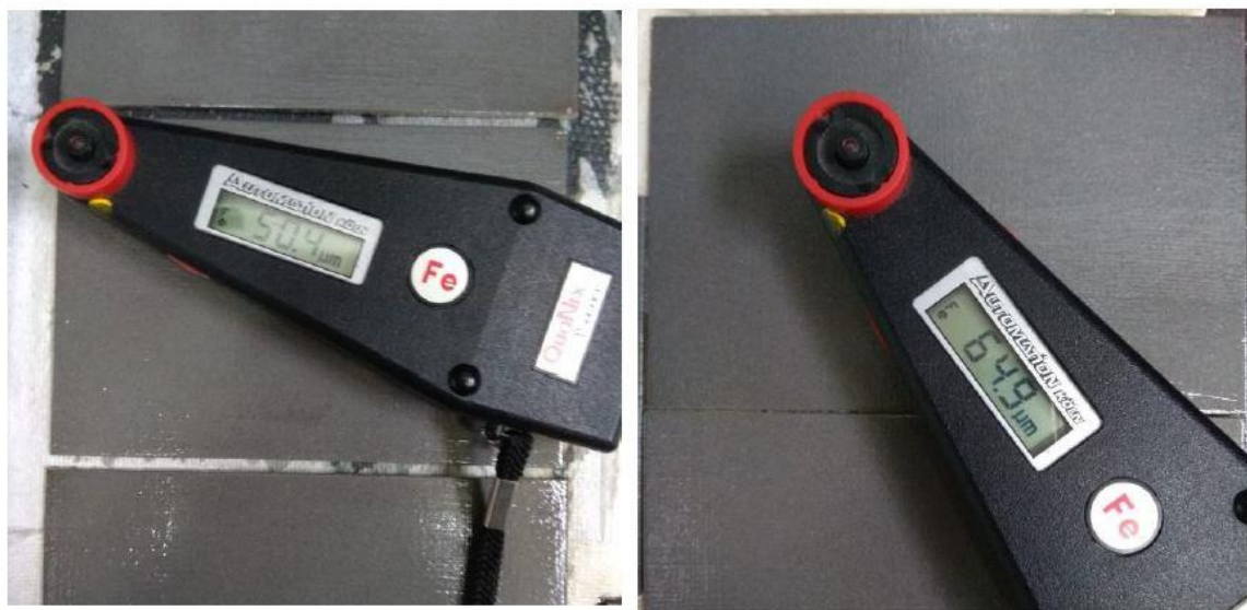
Slika 45. Različite debljine premaza (za isti broj nanesenih slojeva)
