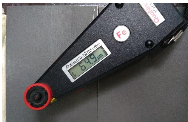
Slika 23. Primjer uređaja za mjerenje debljine suhog filma premaza
