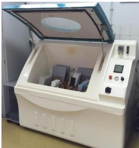
Slika 25. Slana komora “Ascott Model S450”, Laboratorij za zaštitu materijala, FSB
