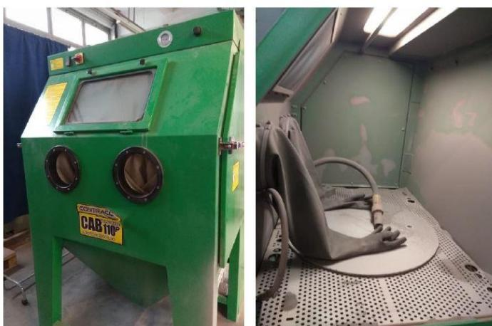
Slika 42. Kabina za pjeskarenje, Laboratorij za ljevarstvo, FSB
