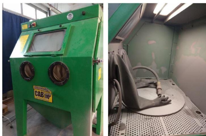
Slika 42. Kabina za pjeskarenje, Laboratorij za ljevarstvo, FSB
