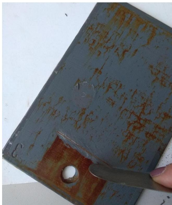
**Slika 28. Uklanjanje premaza u području ureza**
