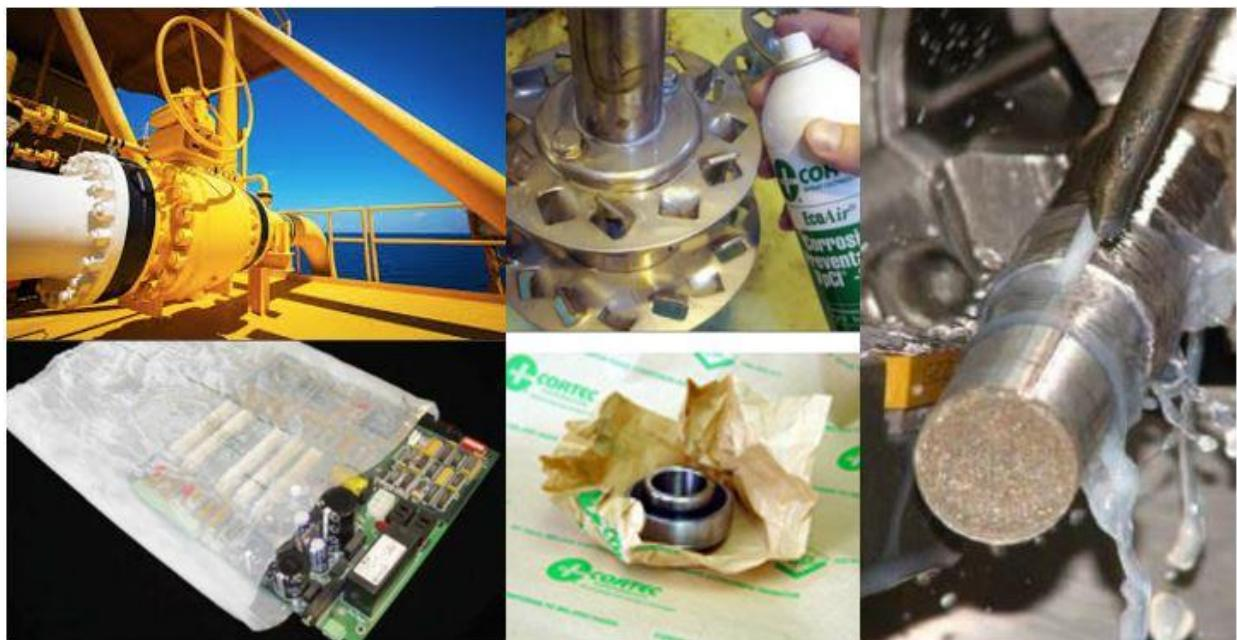
**Slika 20. Različite primjene inhibitora korozije [9], [20]**
