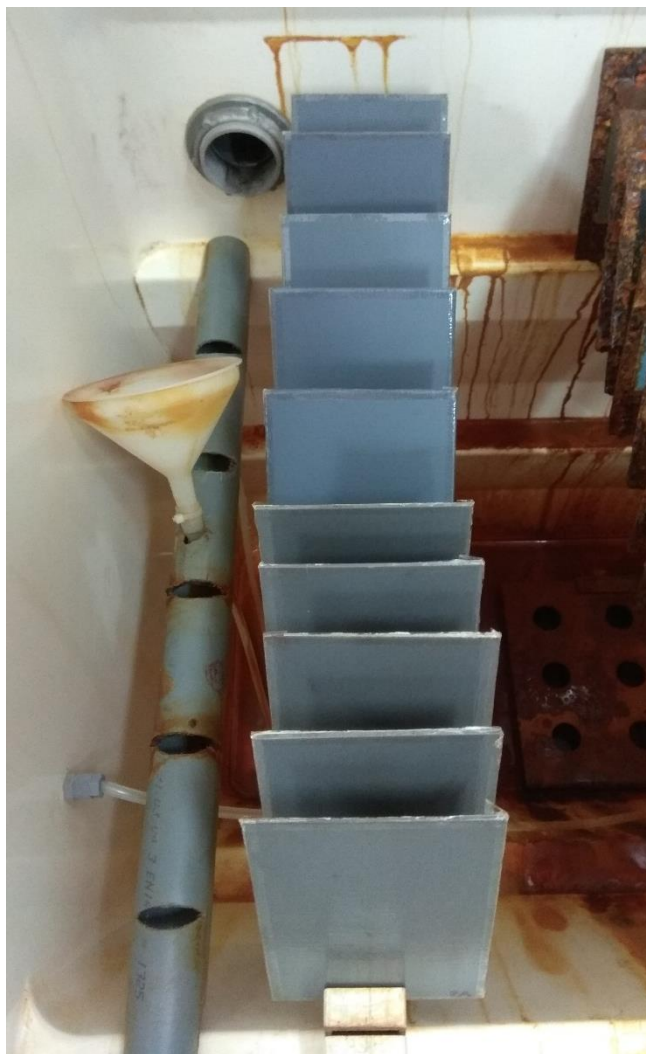
Slika 50. Postavljanje uzoraka na stalak u slanu komoru
