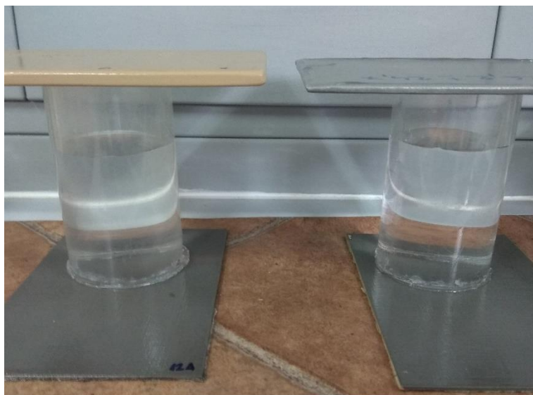
Slika 53. Izlaganje uzoraka otopini 3,5 %-tnog NaCl
