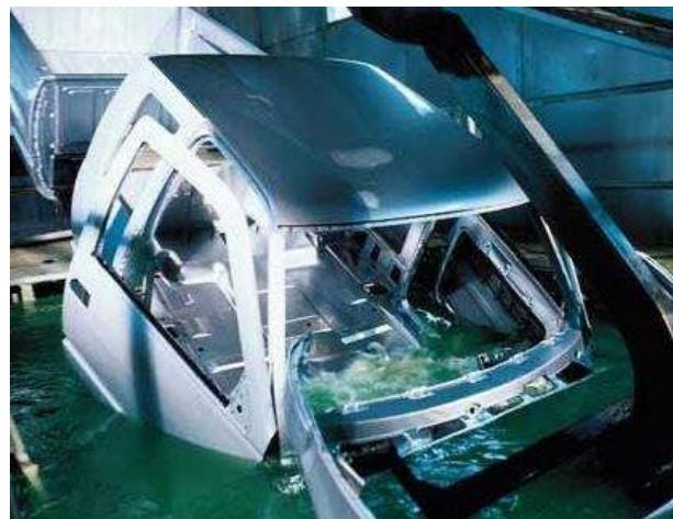
Slika 3. Nanošenje metalne prevlake u autoindustriji [7]
