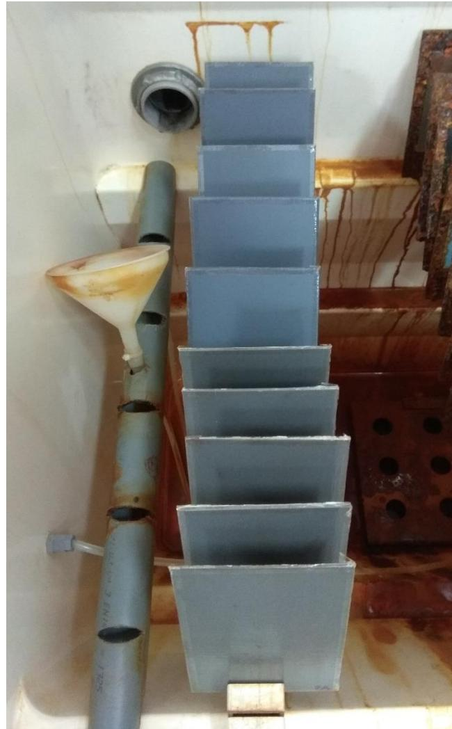
**Slika 50. Postavljanje uzorka na stalak u slanu komoru**
