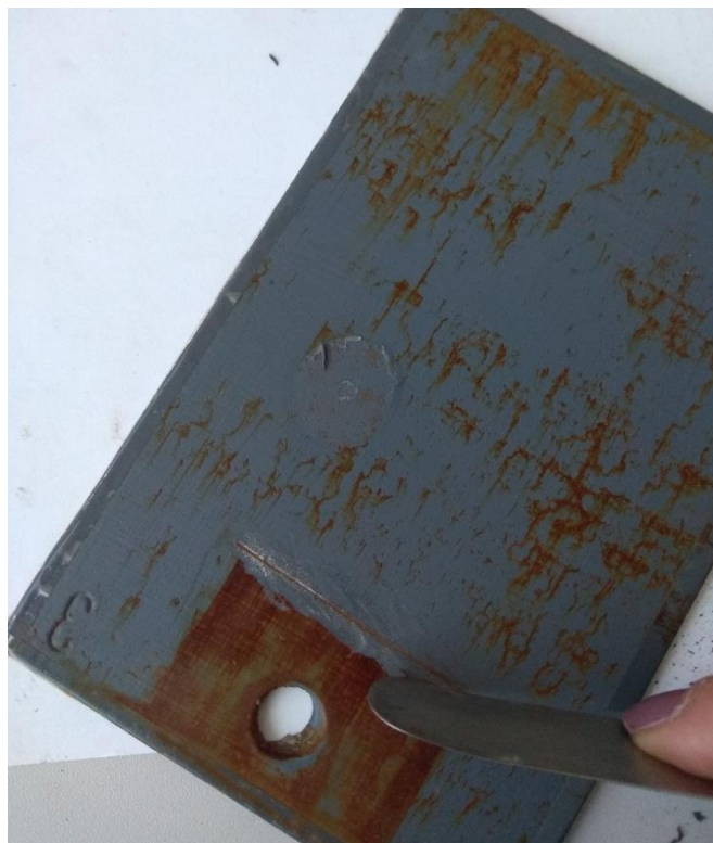
Slika 28. Uklanjanje premaza u području ureza
