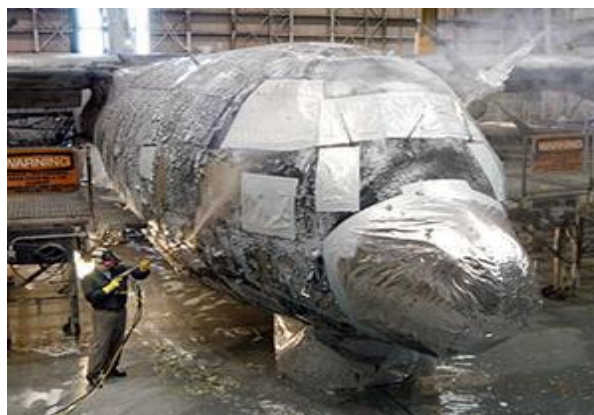
Slika 22. Primjena inhibitora korozije u zrakoplovstvu [25]
