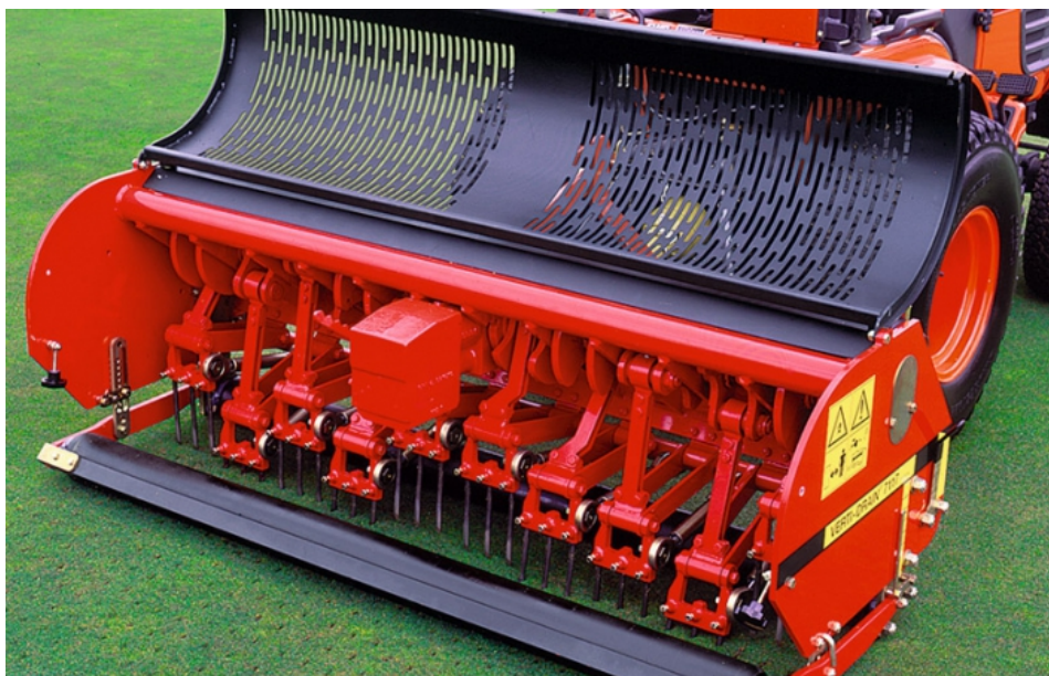
Slika 17. Unutrašnjost prozračivača Verti-Drain 2220 [19]
