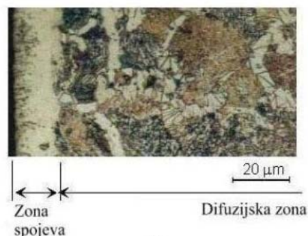
Slika 10. Mikrostruktura rubnog sloja čelika Ck45 u nagriženom stanju (3% NITAL) nakon: a) nitrokarburiranja postupkom TENIFER (TF1 580 °C / 2 h / voda) b) nitrokarburiranja i naknadne oksidacije (postupak TENIFER QPQ) [1]
