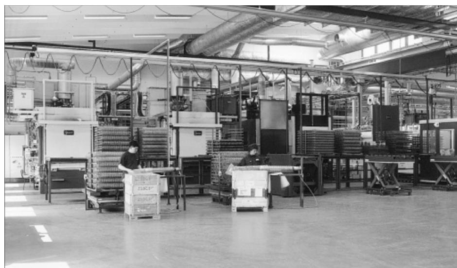
**Slika 3.** Linijski poredane peći u postupku COLOURNITE® [10]
