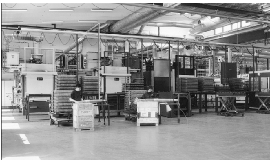
Slika 3. Linijski poredane peći u postupku COLOURNITE® [10]
