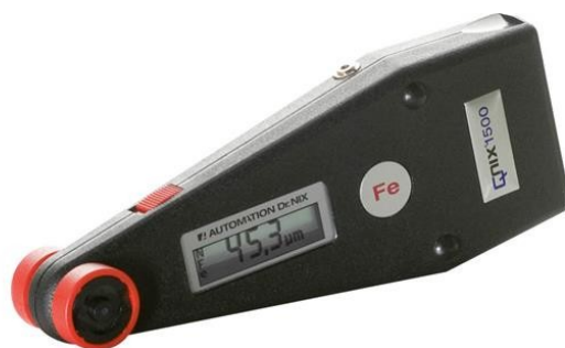
Slika 21. QuaNix 1500 uređaj za mjerenje debljine zaštitnog premaza
