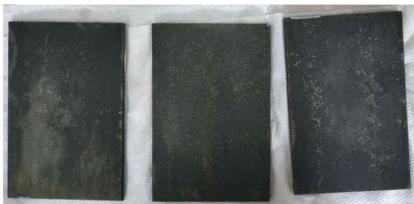
Slika 18. Pločice nakon tretiranja sumpornom kiselinom
