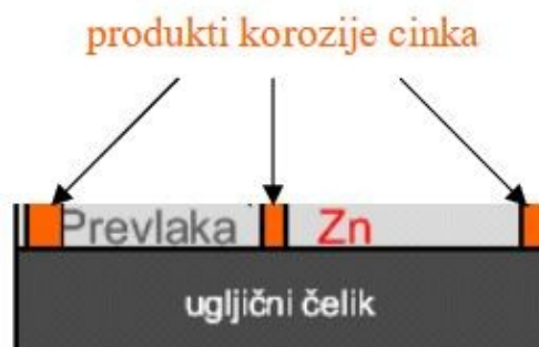
Slika 12. Anodna prevlaka cinka na željezu [9]
