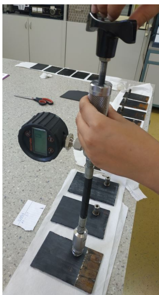
Slika 28. Postupno povećanje sile pri vlačnoj metodi
