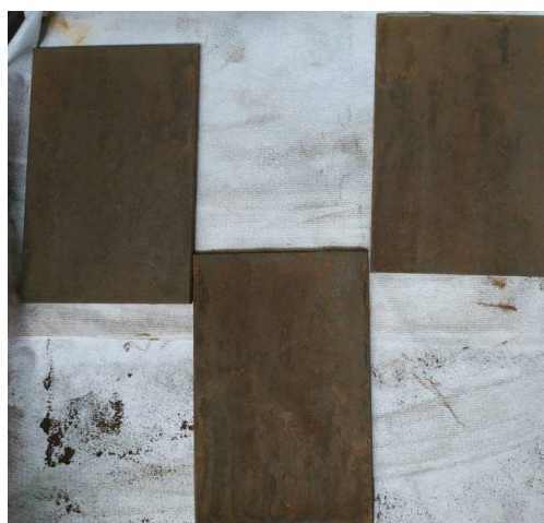
Slika 17. Pločice prije uranjanja u sumpornu kiselinu prekrivene koruzijskim produktima
