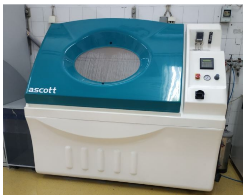
Slika 23. Slana komora Ascott S450, Laboratorij za zaštitu materijala
