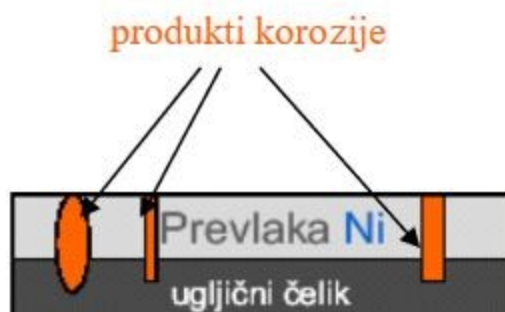
Slika 11. Katodna prevlaka nikla na čeliku [9]
