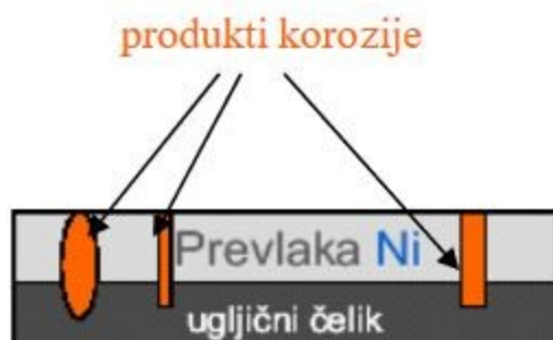
Slika 11. Katodna prevlaka nikla na čeliku [9]
