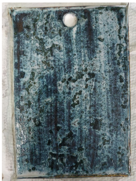
Slika 19. Pločica korodirane površine premazana CorrVerter®-om
