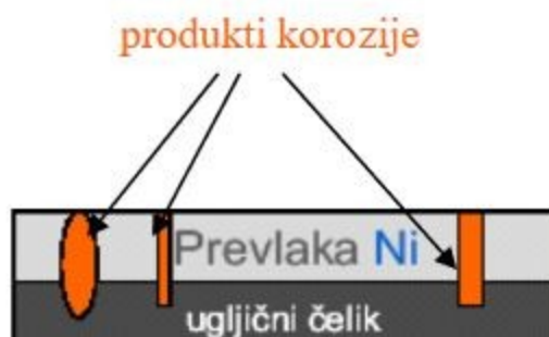
Slika 11. Katodna prevlaka nikla na čeliku [9]
