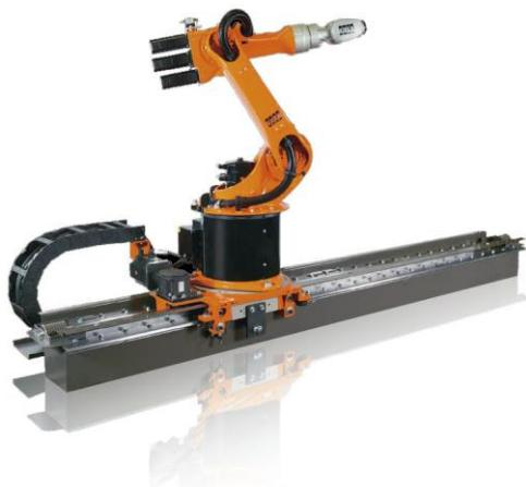
Slika 1. Kuka robotska ruka i vanjski linearni prigon.
