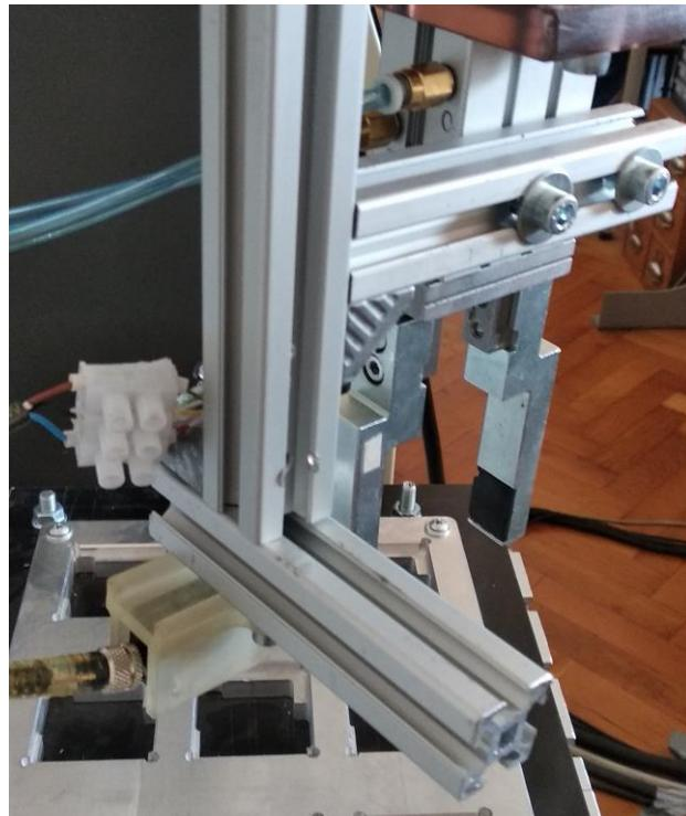
Slika 13. Montaža senzora na pneumatsku hvataljku
