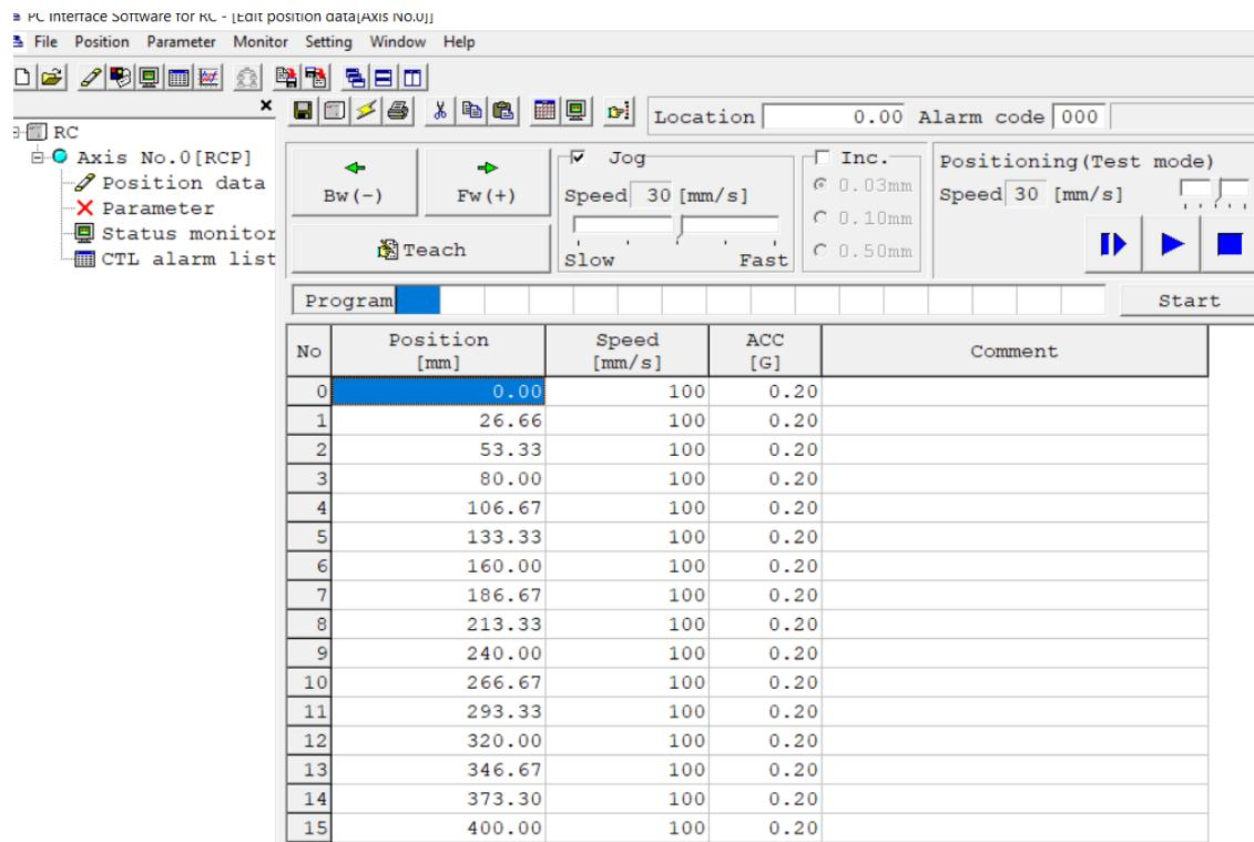
**Slika 10.** Program na računalu za postavljanje postavaka na PLC-u linearog prigona
