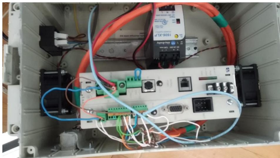
**Slika 8. PLC.a lineaernog prigona**
