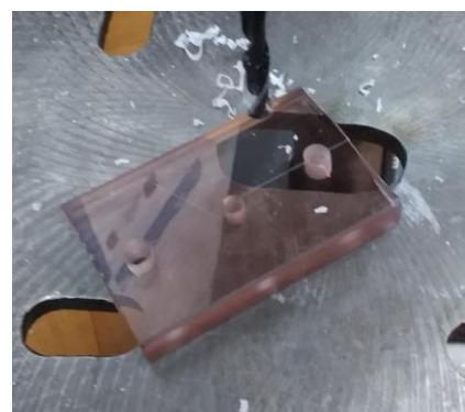
Slika 15. Akrilne pločice za montažu hvataljke
