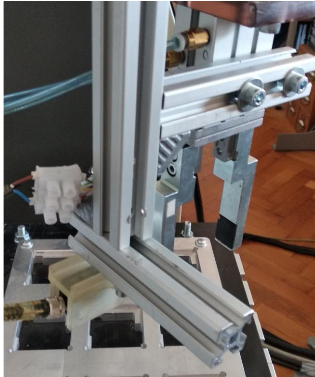
Slika 13. Montaža senzora na pneumatsku hvataljku
