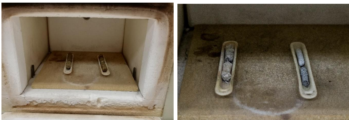
Slika 14. Uzorci prije žarenja (lijevo) i poslije žarenja (desno)
