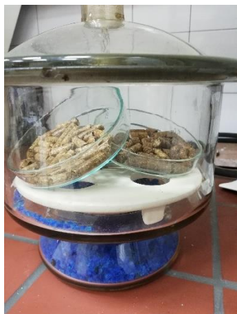
Slika 11. Hlađenje u eksikatoru (lijevo) i vaganje uzoraka nakon sušenja (desno)
