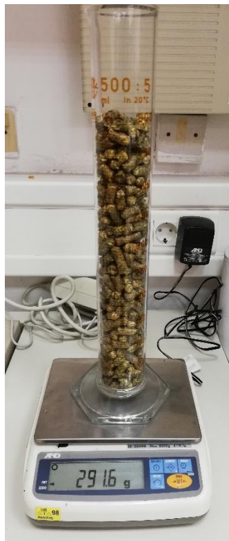
Slika 13. Određivanje nasipne gustoće
