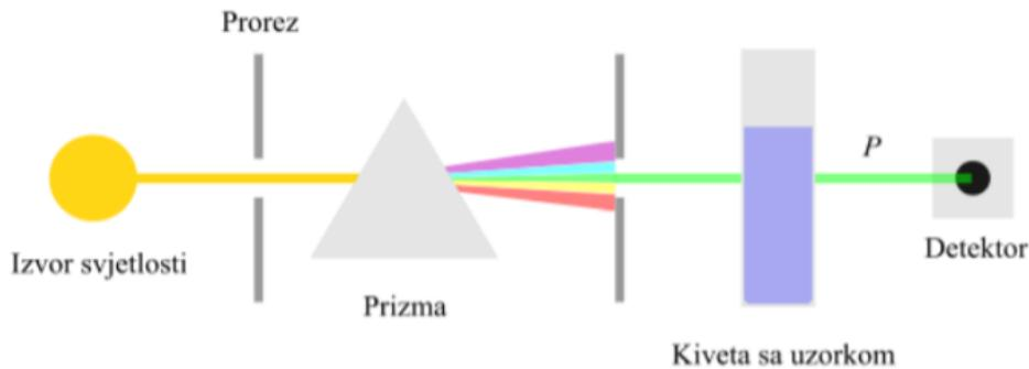
**Slika 3. Pojednostavljena shema uređaja za mjerjenje UV apsorbancije**
