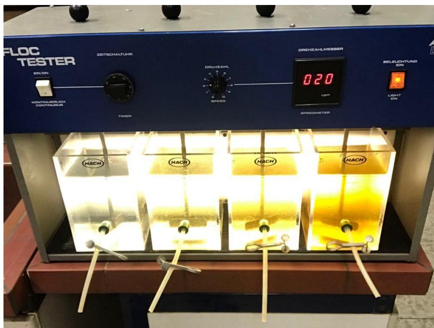
**Slika 7. Aqualytic Floc Tester (Model AMF 4, Njemačka)**
