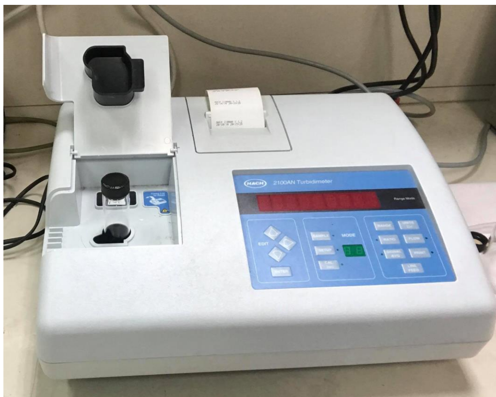
Slika 4. HACH 2100AN turbidimetar
