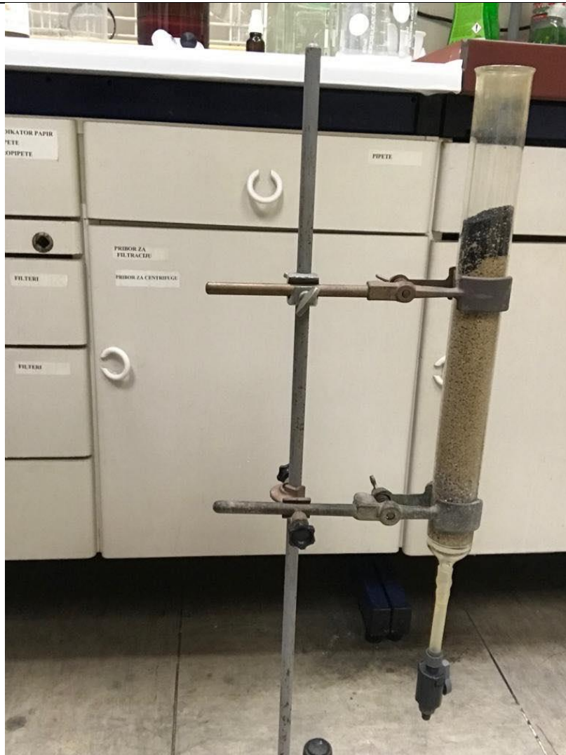
Slika 9. Gravitacijski višeslojni filter
