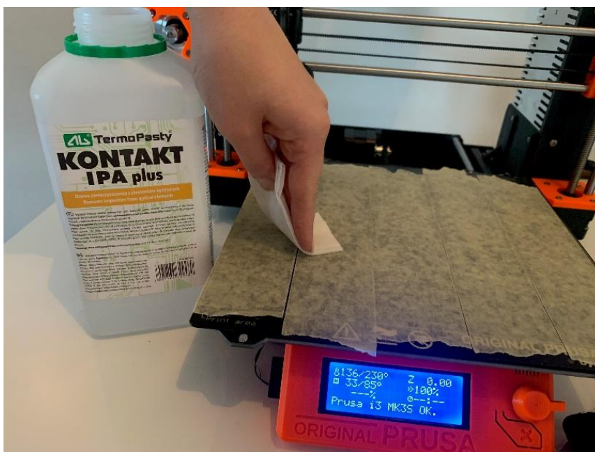
Slika 22. Priprema površine platforme za 3D ispis
