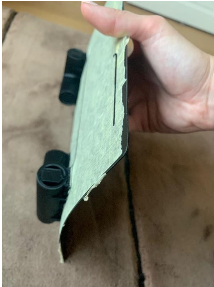
Slika 23. Odvajanje od platforme; prejako prijanjanje
