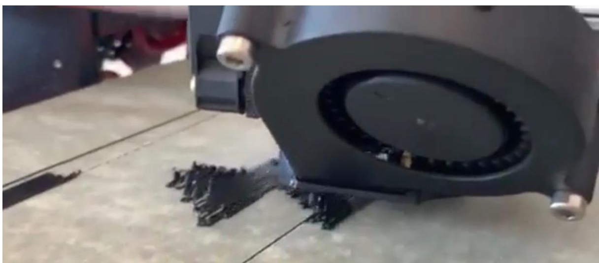
Slika 24. Slabo lijepljenje prvog sloja
