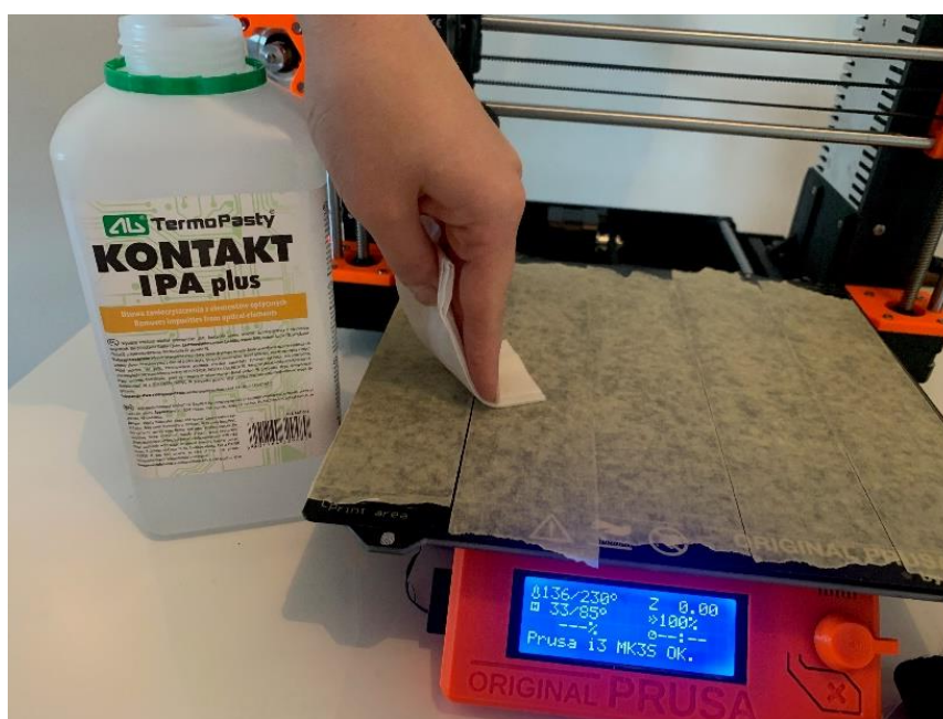
Slika 22. Priprema površine platforme za 3D ispis
