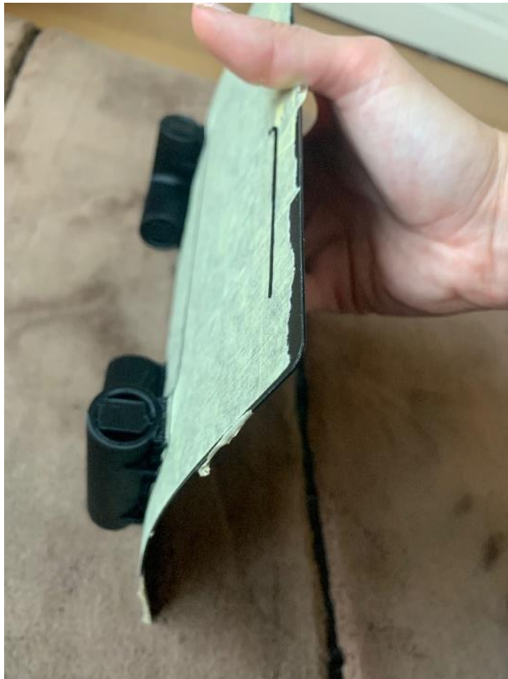
Slika 23. Odvajanje od platforme; prejako prijanjanje
