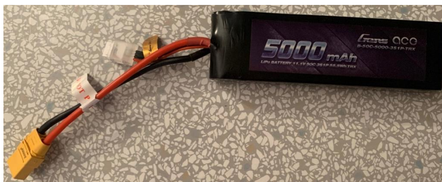
Slika 36. Baterija Gens Ace 5000 mAh, 50 C
