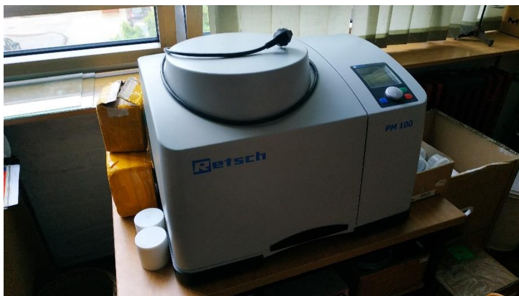
Slika 18. Planetarni kuglični mlin Retsch PM 100
